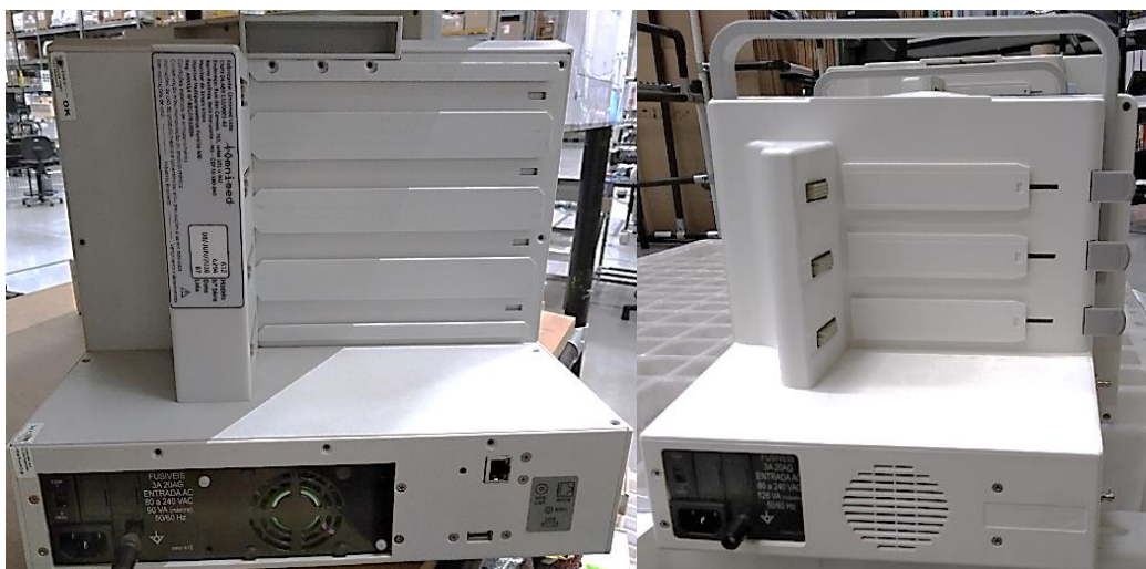
Figura 6 - Gabinete usinado e com “pocket” (Família 600) x gabinete injetado e com alça (Família 700)
