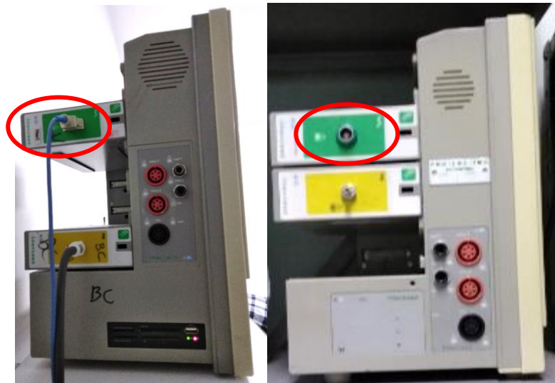
Figura 11 - Configurações diferentes de SpO2 (oximetria) para o fabricante Omnimed
