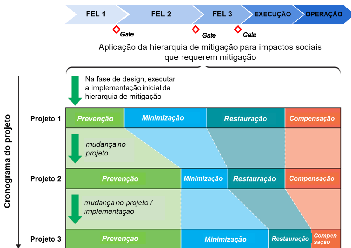
Figura 27 - Aumento do uso de prevenção e minimização no projeto (fase de desenvolvimento) por meio da aplicação iterativa da hierarquia de mitigação.
