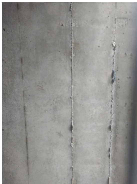
Figura 8 Parede de concreto para realização dos ensaios de aderência a tração e determinação do tempo aberto.
