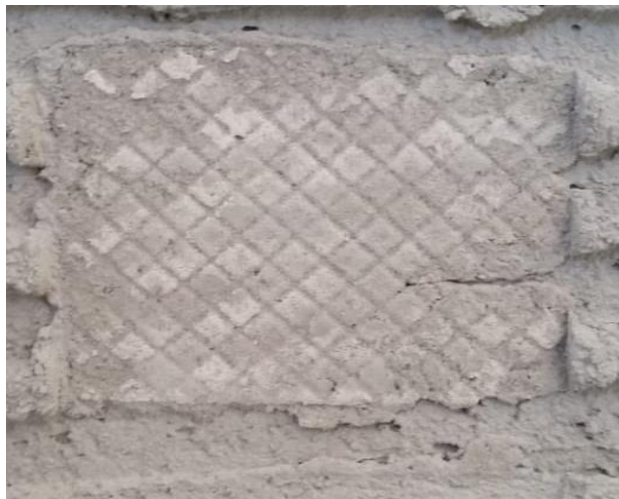
Figura 15 Face da parede de concreto não lavada após ruptura - Argamassa do fabricante 3 do tipo C2.
