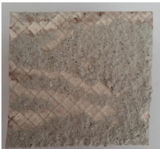
Figura 18 Ruptura do revestimento cerâmico utilizando a argamassa fabricante 1 do tipo AC-I.
