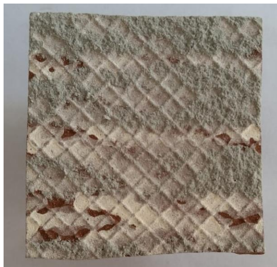
Figura 22 Ruptura do revestimento cerâmico utilizando a argamassa fabricante 1 do tipo AC-III.
