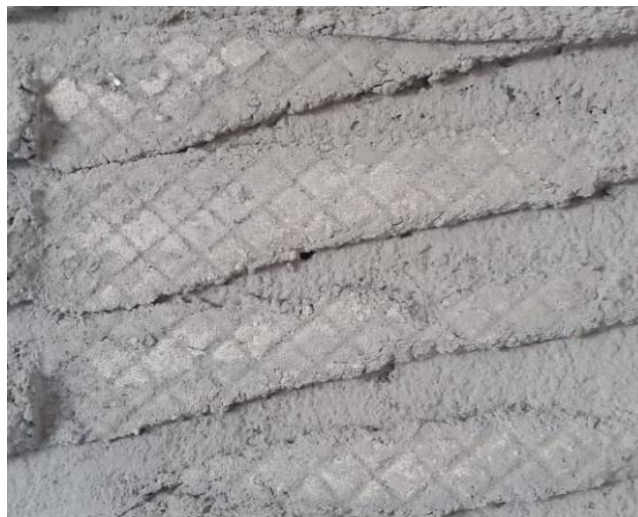
Figura 25 Face da parede de concreto não lavada após ruptura - Argamassa do fabricante 2 do tipo AC-I.
