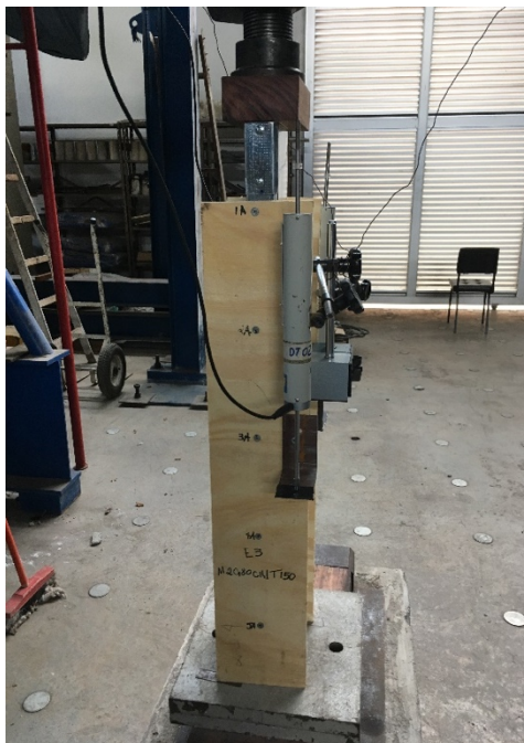
Figura 4.4: Modelo M2 pronto para o ensaio push test
