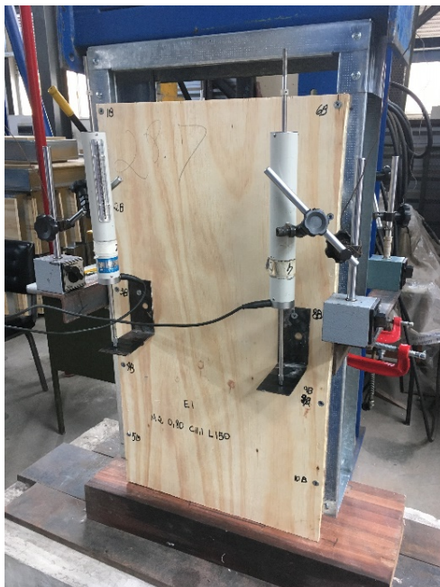
Figura 4.2: Modelo M1 pronto para o ensaio push test
