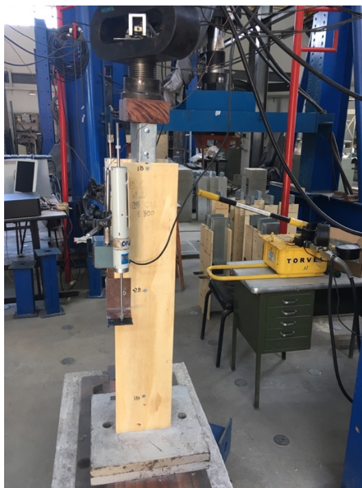
Figura 4.7: Foto da bomba hidráulica da marca Torvel ao fundo da imagem e do anel dinamométrico acima do espécime.
