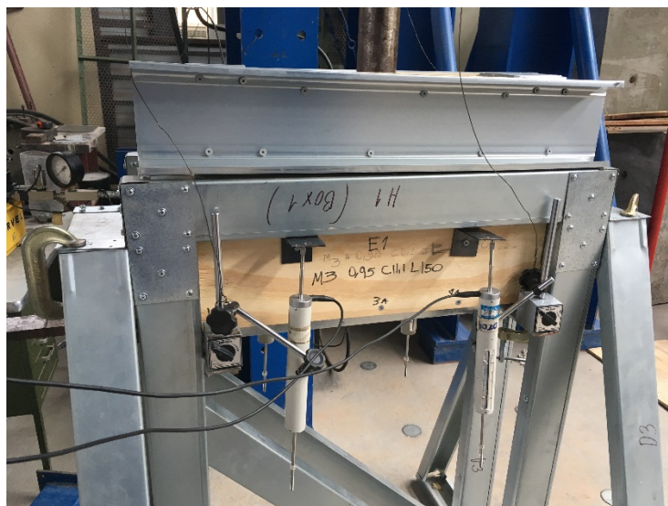
Figura 4.6: Modelo M3 pronto para o ensaio push test
