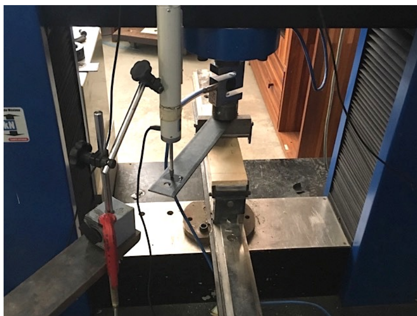
Figura 3.6: Máquina universal de ensaios EMIC DL-30.000 vista de cima e o DT durante a realização dos ensaios.
