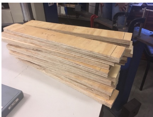
Figura 3.3: Corpos de prova de 18,3 mm antes do ensaio de flexão.
