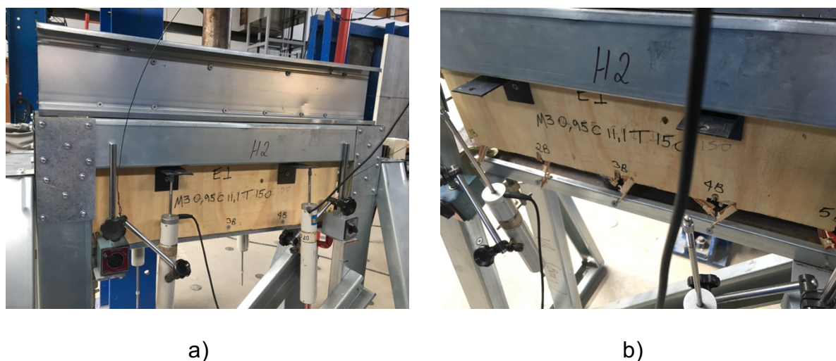
Figura 4.12: Exemplo de cisalhamento com rasgamento na placa de compensado no espécime M3 0,95 C11,1 T150 – E1. a) modelo antes do ensaio; b) cisalhamento com rasgamento nas placas, durante o ensaio.
