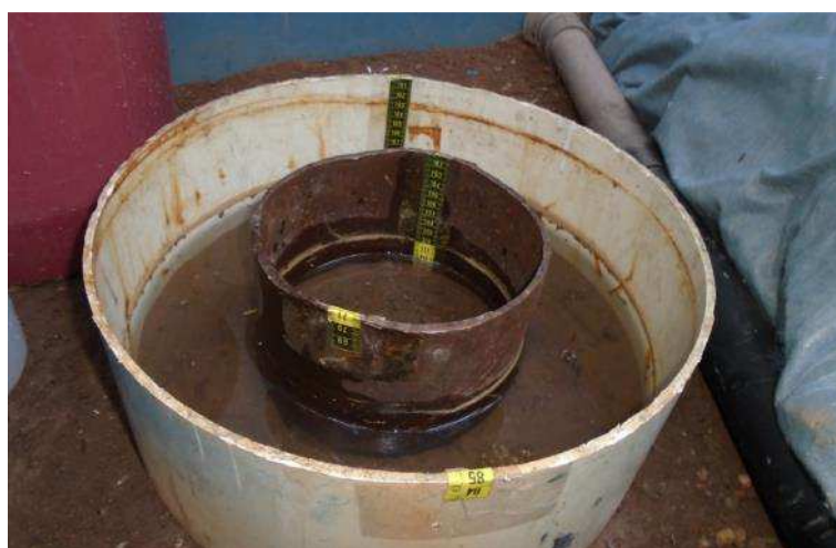
Figura 7.25: Ensaio de permeabilidade de duplo anel realizado no interior do microrreservatório M-RNE
