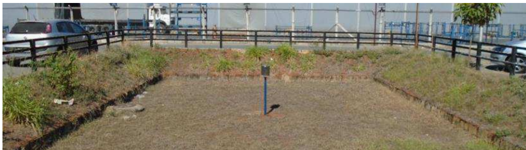
Figura 6.15: Pluviômetro instalado sobre o microrreservatório MV-2
