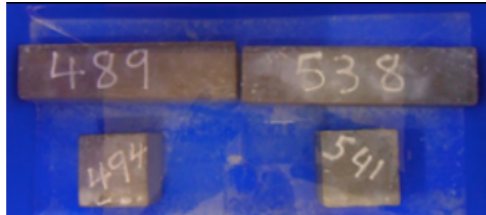
Figura 4.11 Corpos de prova após 630 dias de imersão em solução Solução: Combinação sulfato e 2,0% de cloreto (SC20): (a) CEMI e (b) CEMI-LF
