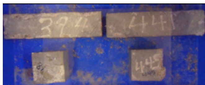
Figura 4.10 Corpos de prova após 630 dias de imersão em solução Solução: Combinação sulfato e 1,0% de cloreto (SC10): (a) CEMI e (b) CEMI-LF
