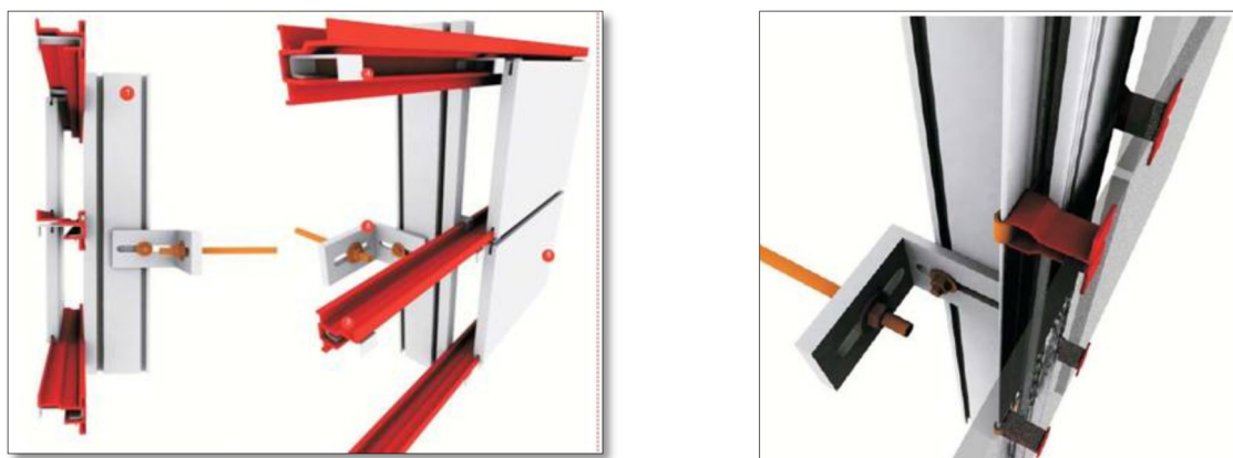
FIGURA 3: Fixação para revestimentos de grande espessura
