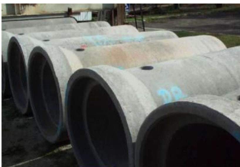
Figura 22: Manilhas fabricadas em concreto geopolímero (D=150mm)
