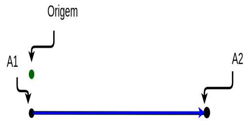
Figura 4.18: Projeção do ponto de origem posicionada no ponto de origem (A1) da via.
