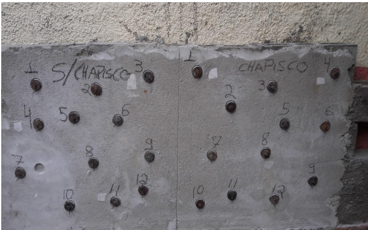
Figura 16 – Placas posicionadas para o ensaio de resistência de aderência á tração. Fonte: (autor)
