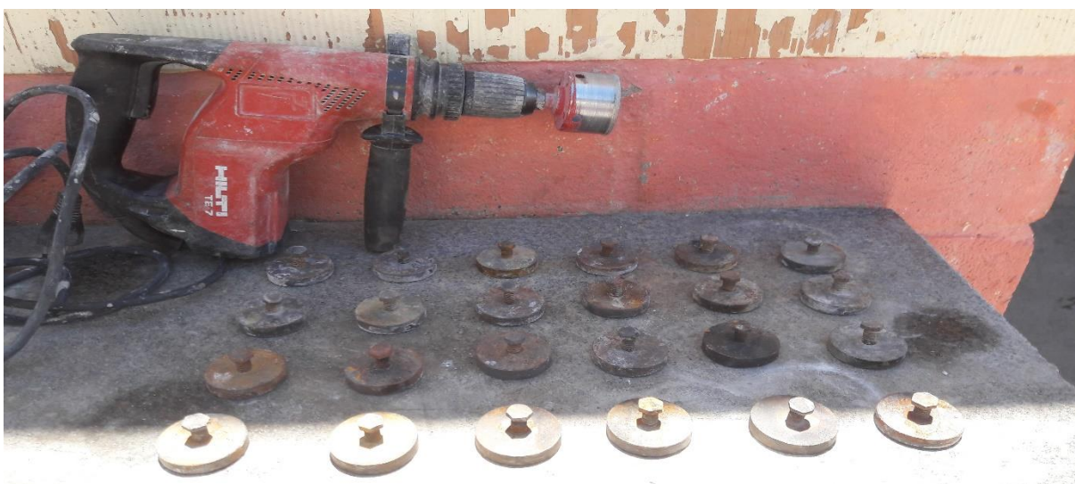
Figura 15 – Equipamento utilizado para realização dos furos no painel de teste. Fonte: (autor)
