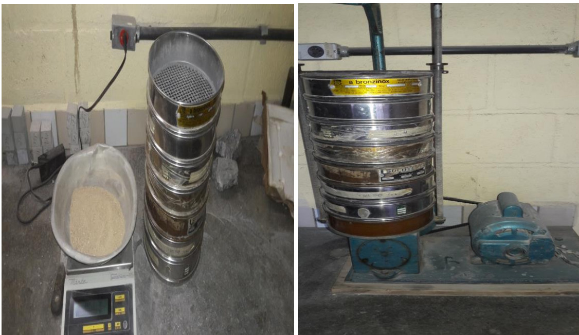
Figura 8 – Ensaio de granulometria. Fonte: (autor)
