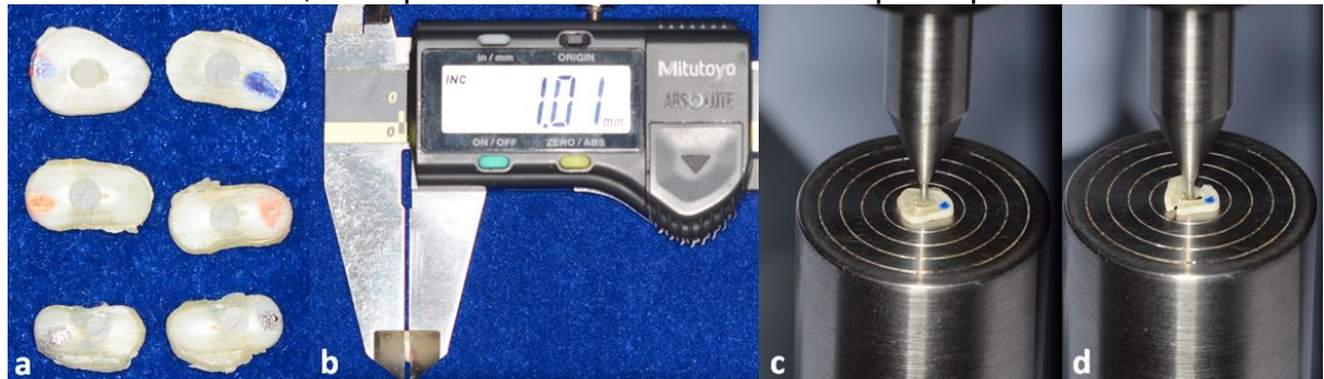
Figura 21 - a. Espécimes obtidos em cada terço radicular, b. Verificação da espessura do espécime, c. Espécime posicionado sobre a base metálica para ser submetido ao teste, d. Espécime com deslocamento do pino após teste.
