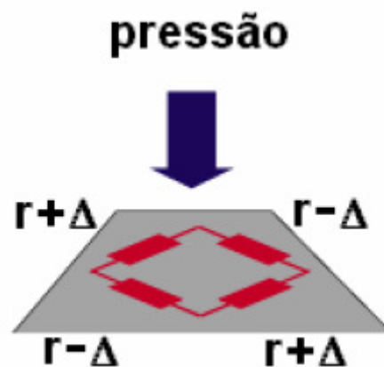
Figura 3-29: Configuração de um resistor integrado
