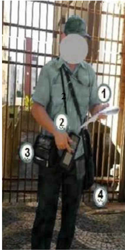
FIGURA 2 – Disposição dos instrumentos e acessórios durante a atividade: 1- bl; 2- coletor de dados; 3- impressora portátil; 4- bolsa lateral (uso opcional).
