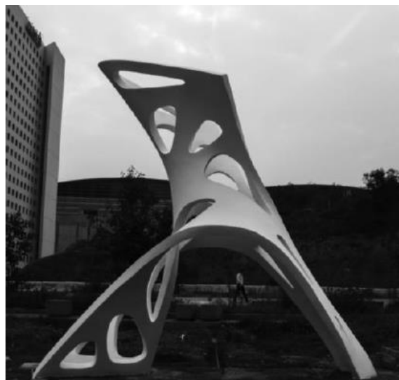
FIGURA 54 - Concepção estrutural por meio de técnica de otimização topológica realizado pelo Zaha Hadid Architect's CODE group
