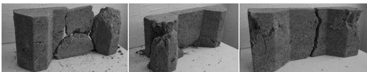
FIGURA 95 - Bloco A, B e D respectivamente e suas linhas de fissura após ensaio de compressão Fonte: MARTINS, 2018.
