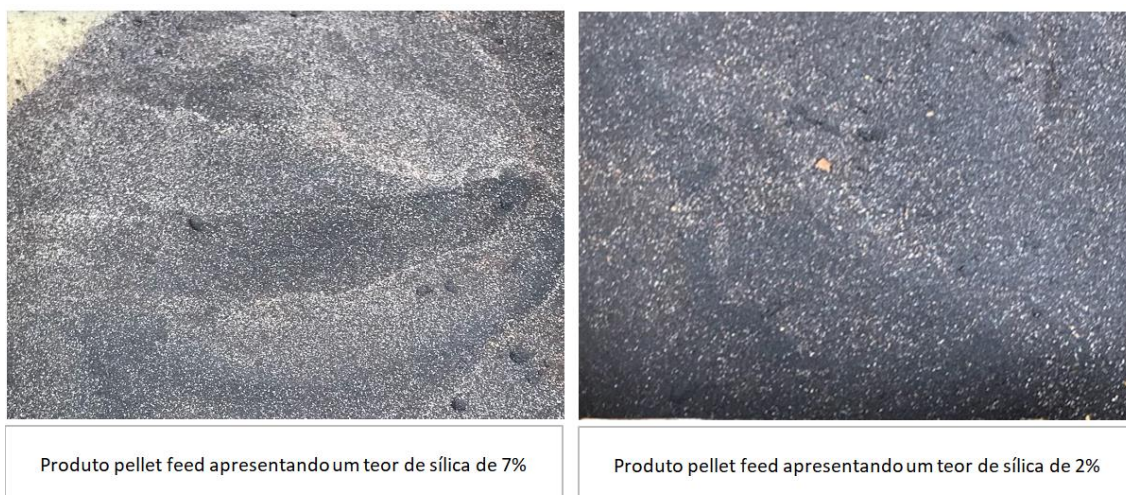
Figura 8: Produto pellet feed com níveis de contaminante diferentes, sendo a da esquerda com um teor de 7% de contaminante, à esquerda o mesmo produto, contudo com um teor de sílica de 2%. Os pontos brancos na massa mineral podem ser considerados como representantes de partículas de sílica – referência de tamanho na seção Apêndice.
