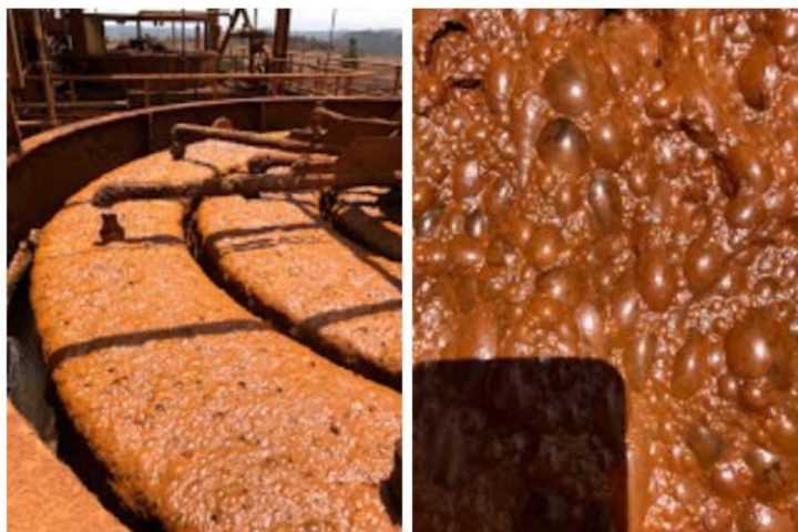
Figura 14: Equipamento de flotação industrial. Na foto à esquerda podemos ver um equipamento de flotação industrial e o fluxo de rejeito contendo as partículas de sílica, a foto à direita mostra um detalhe da espuma que sai do mesmo equipamento contendo as partículas de sílica. Fonte: arquivo do autor.
