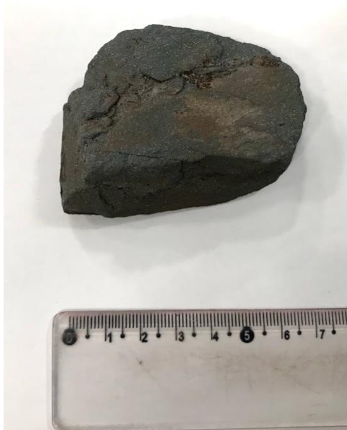
Apêndice 4: Referência de dimensão para as partículas de Lump Ore de minério de ferro.
