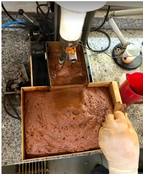
Figura 13: Equipamento de flotação em bancada. Fonte: arquivo do autor.
