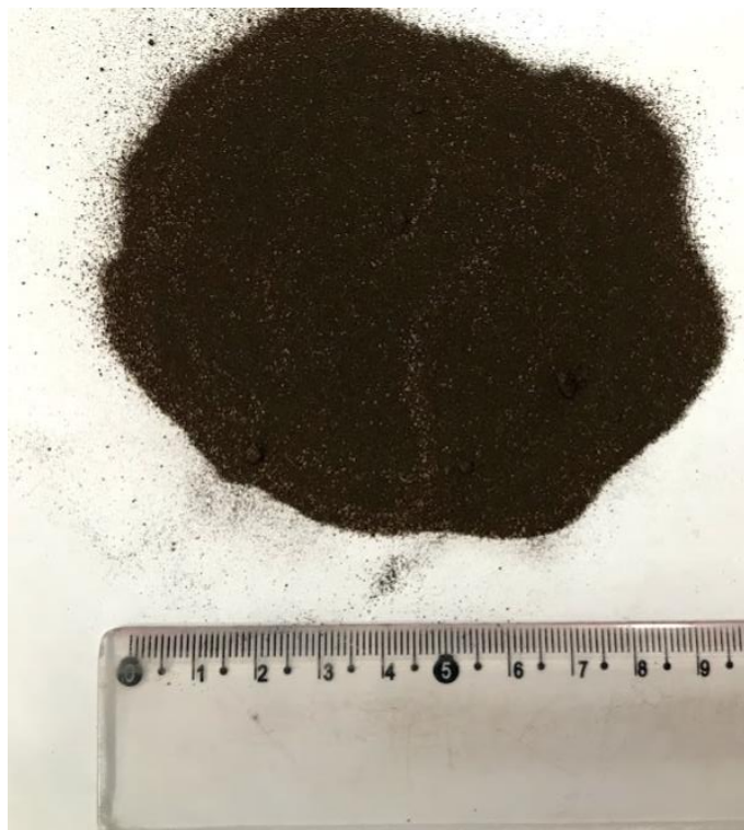
Apêndice 5: Referência de dimensão para as partículas de pellet feed de minério de ferro.
