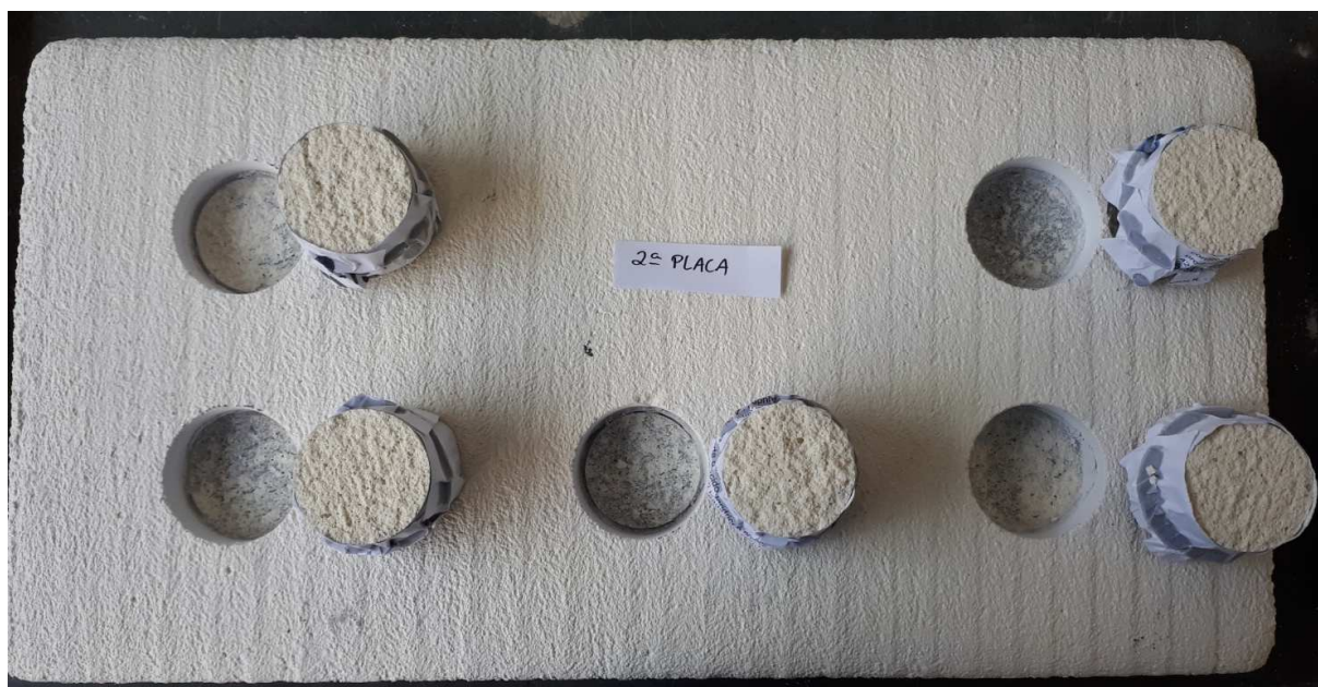
Figura 38 - Placa de substrato padrão após o ensaio de resistência a aderência à tração
