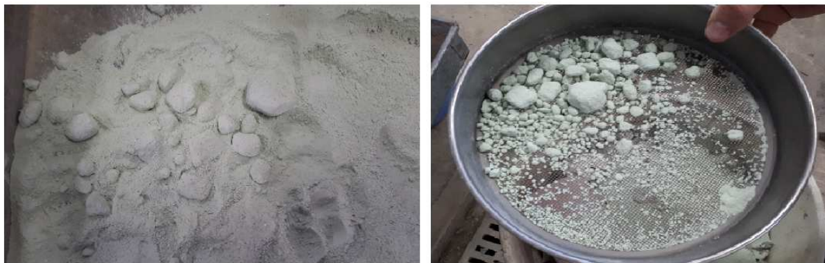
Figura 20 - Grumos de material já hidratado encontrado em 1,5kg de ATD.
