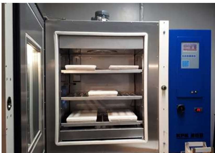
Figura 30 - Disposição das placas de substrato padrão dentro da câmara de intemperismo.
