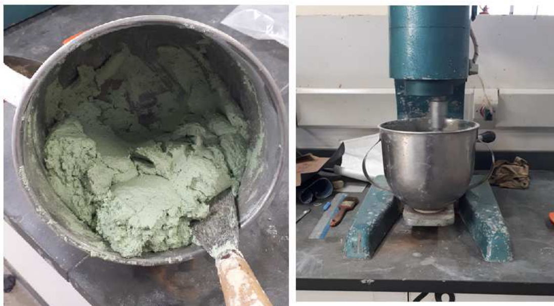
Figura 21 - Mistura manual inicial da ATD com a água e a argamassadeira Contenco.
