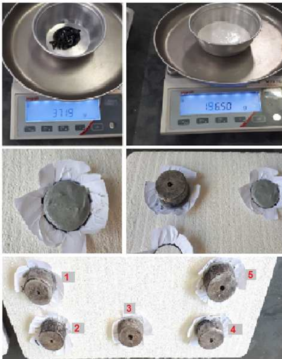
Figura 36 - Sequência de colagem da pastilha
