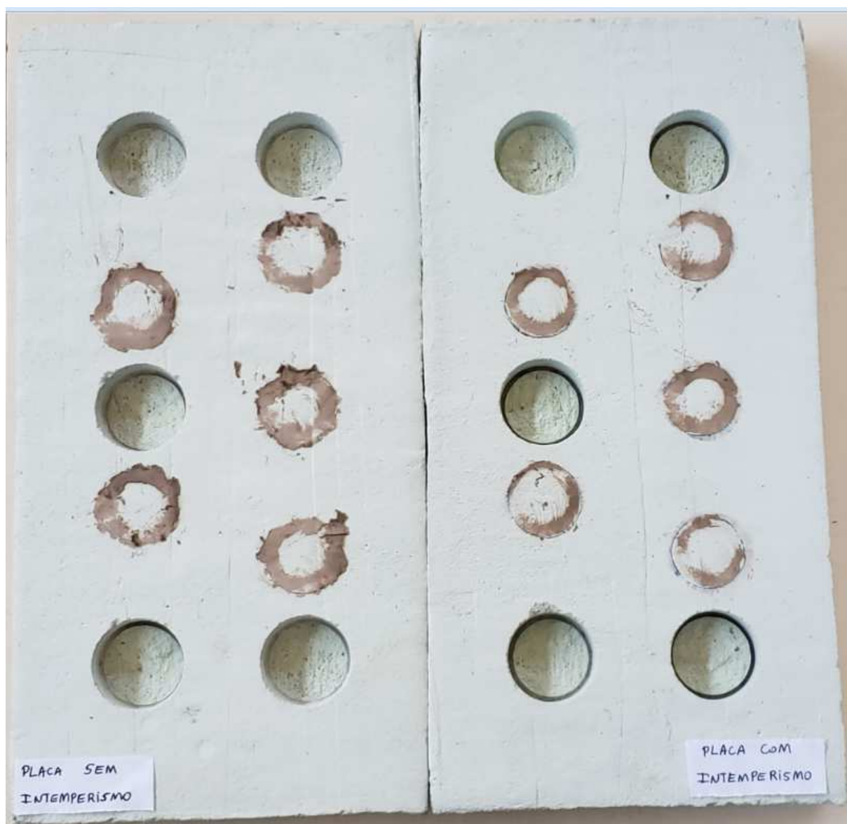
Figura 44 - ATDs executados em 01/08/2018 sem e com intemperismo.
