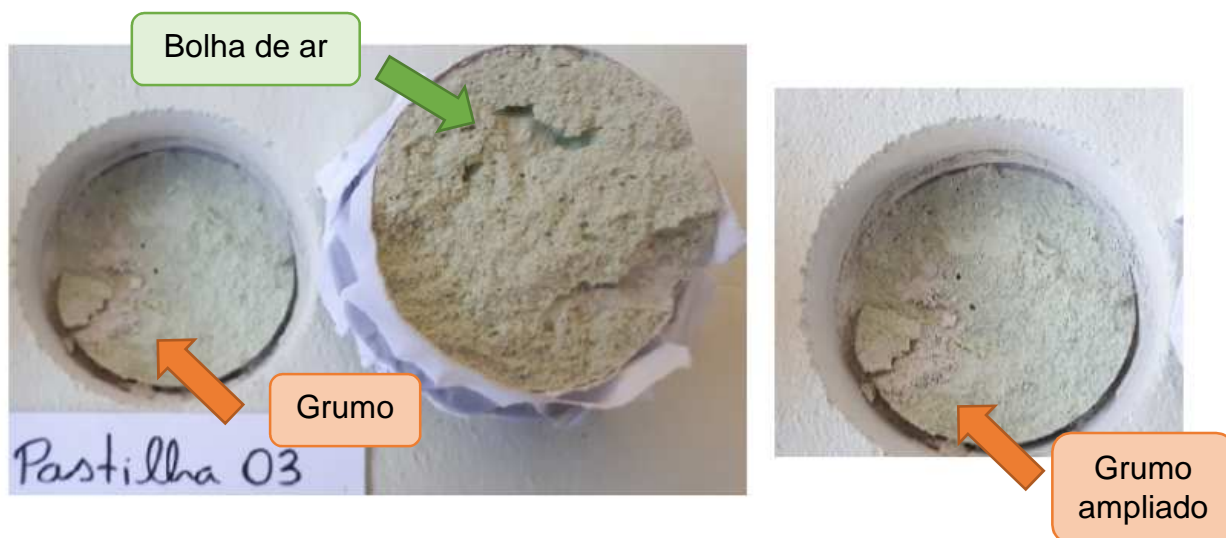
Figura 50 – Grumos e vazios que permaneceram na mistura após destorroamento manual e a aplicação.
