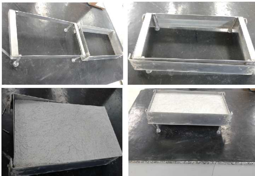
Figura 13 - gabarito articulado confeccionado pelo fabricante conforme a NBR 13276:2016.
