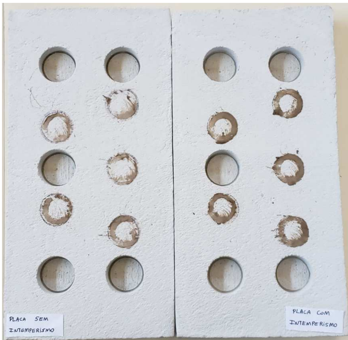
Figura 45 - ATDs executados em 26/09/2018 sem e com intemperismo.
