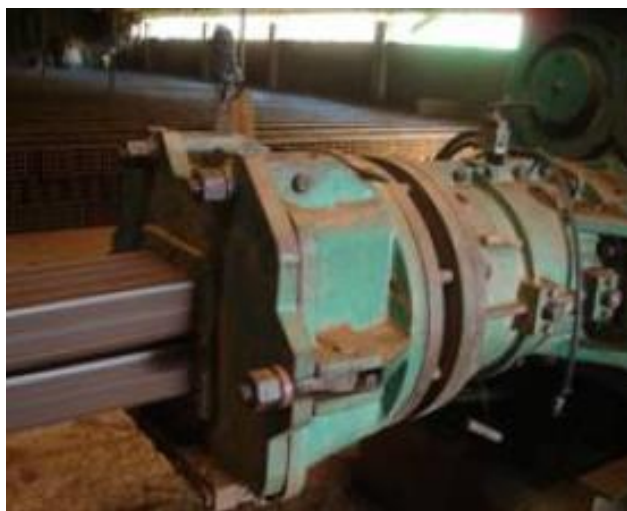
Figura 6: Produção de Blocos - boquilha de moldagem
