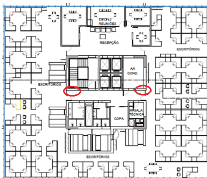
Figura 17: Indicação da localização dos interruptores de iluminação
