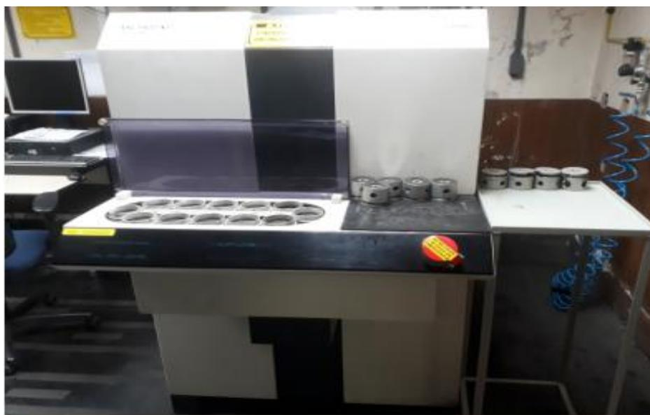
Figura 4.11 - Espectrômetro de Raios – X ARL 9800 XP
