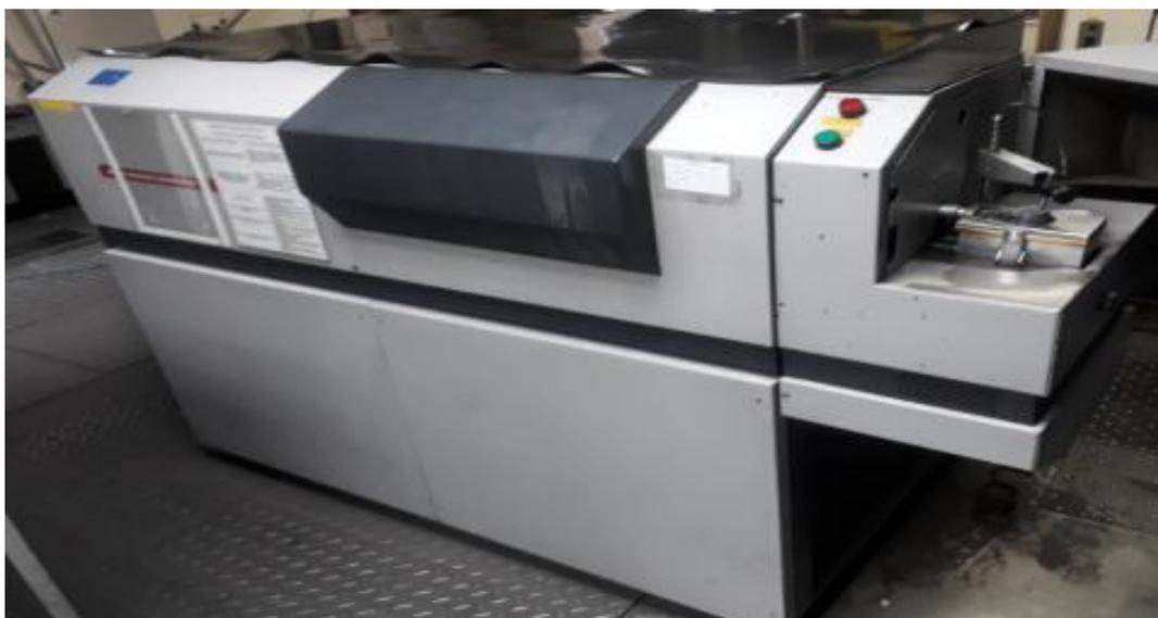
Figura 4.6 - Espectrômetro de emissão ótica ARL 4460
