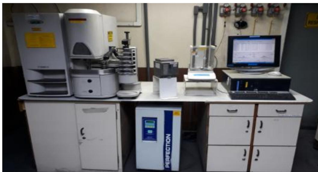
Figura 4.7 - Analisador de Enxofre e Carbono LECO CS-600
