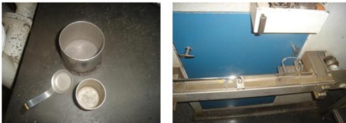
Figura 4.10 - Imagem à esquerda indica um dosador e recipiente para preparação da amostra de escória, e à direita, o aparelho responsável pela preparação automática da amostra
