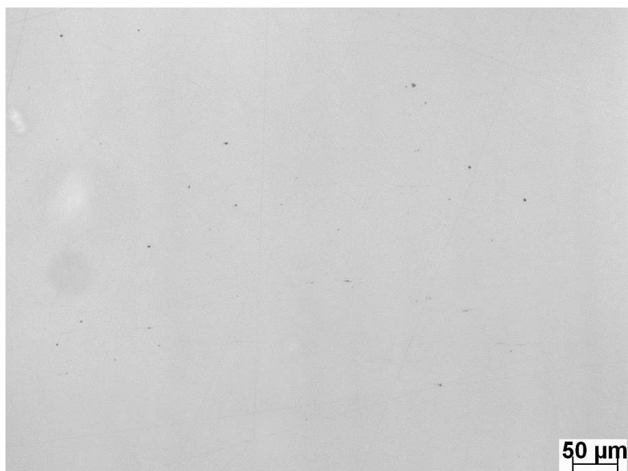
FIGURA 5.2 – Aspecto representativo de inclusões da amostra DP600. Sem ataque. Ampliação original: 200x.
