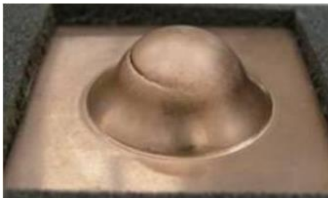
FIGURA 3.18 - Aspecto do corpo de prova fraturado após ensaio de estampabilidade (adaptado de documentos internos da USIMINAS)
