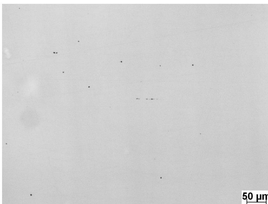
FIGURA 5.1 – Aspecto representativo de inclusões da amostra FB580. Sem ataque. Ampliação original: 200x.
