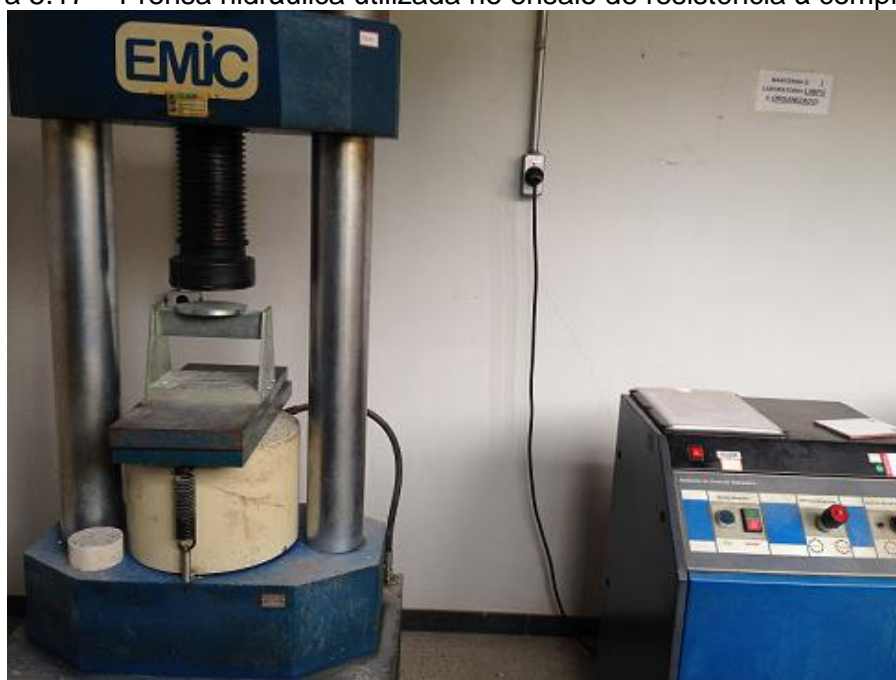
Figura 5.17 – Prensa hidráulica utilizada no ensaio de resistência à compressão
