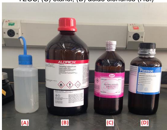
Figura 5.2 – Reagentes utilizados na síntese da sílica sol-gel: (A) água deionizada; (B) TEOS; (C) etanol; (D) ácido clorídrico (HCl)
