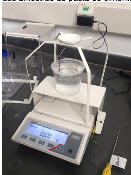
Figura 5.15 – Aparato acoplado à balança para determinação da densidade e porosidade das amostras de pasta de cimento
