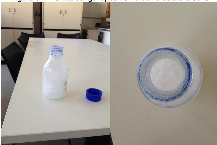
Figura 5.4 – Sílica sol-gel após 48 horas na estufa a 90°C
