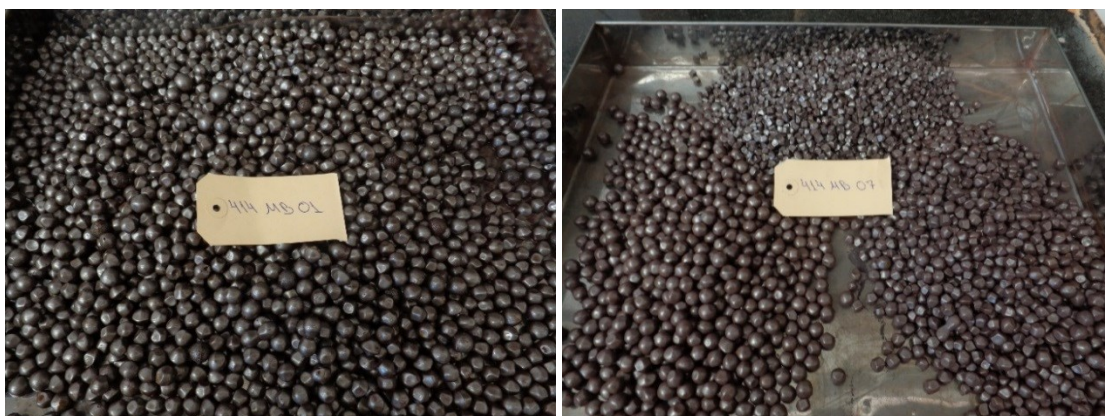
Figura 5.1 -Fotos dos corpos moedores com reposição de (a) bolas novas e (b) bolas reutilizadas
