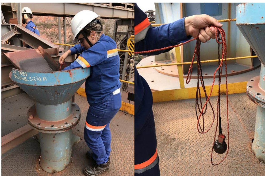
Figura 4.3 - a) Foto do procedimento de medição do grau de enchimento. b) Foto do artefato utilizado para realizar a medição (ESTEVES et al. , 2018).
