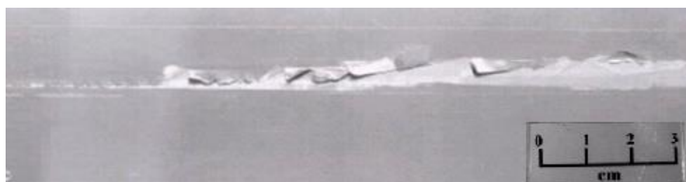
Figura 3.4 - Efeito causado por inclusões de alumina em bobina de aço (NASCIMENTO, 2008)
