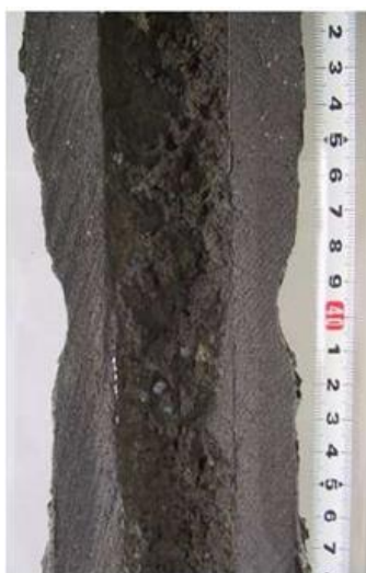
Figura 3.7 - Aparência interna de uma válvula submersa que apresentou obstrução (YANG et al., 2011)
