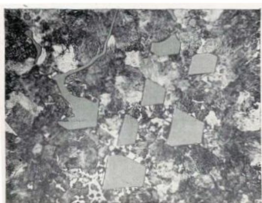
Figura 3.23 - Seção com aumento original de 225x, apresentando inclusões de sulfeto de Manganês (COLPAERT, 1983)
