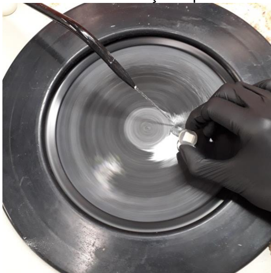
FIGURA 5 – Planificação e polimento do espécime
