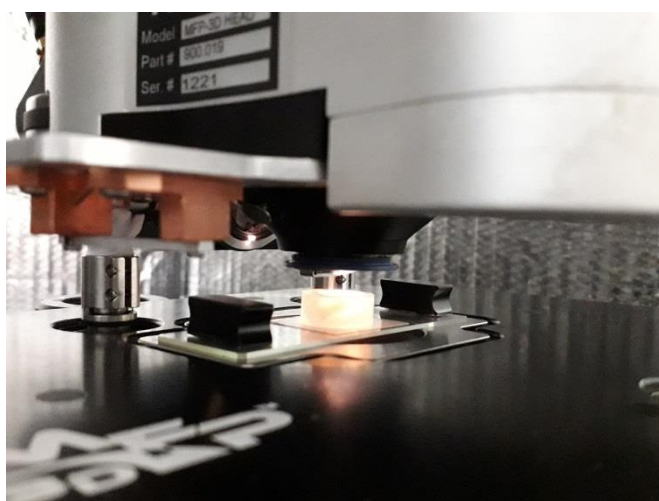
FIGURA 20 – Espécime posicionado em Microscópio de Força Atômica
