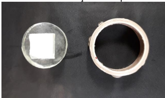
FIGURA 4 – Remoção do espécime da matriz de PVC
