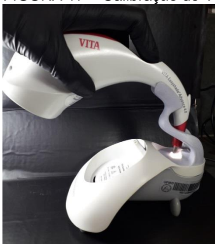
FIGURA 17 – Calibração do VITA Easyshade Advance 4.0
