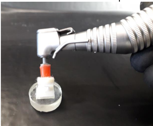
FIGURA 6 – Polimento do espécime com pasta e disco de feltro
