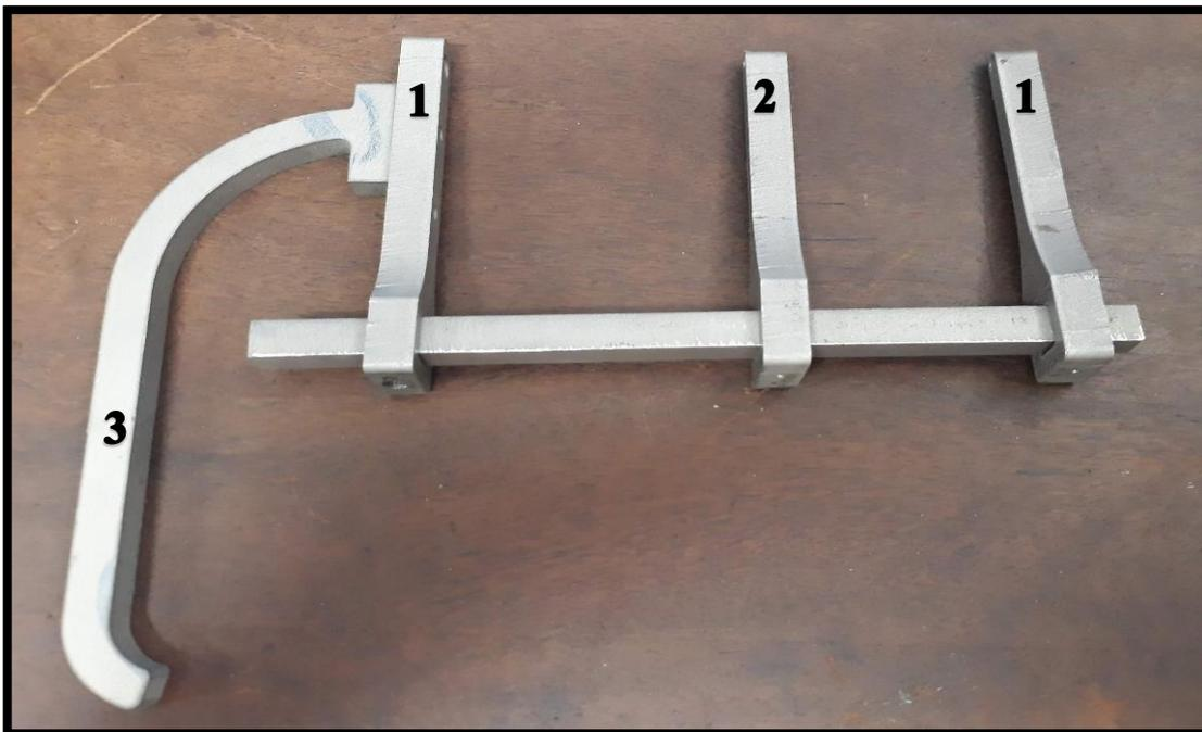
Figura 15. Fotografia do guia definitivo em aço inoxidável 316L composto por duas hastes externas (1), uma haste interna (2) e um cabo para manipulação (3).
