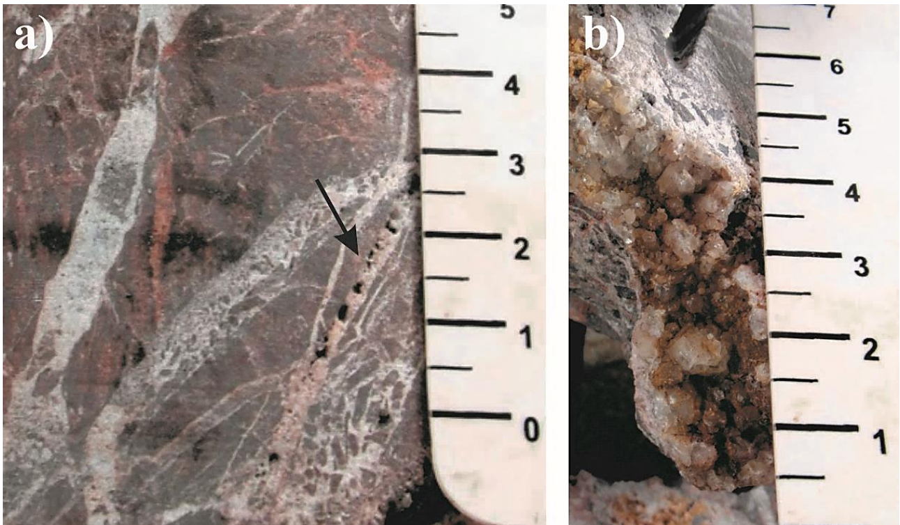
Figura 4.8: Cavidades com preenchimento na amostra 003 do furo de sondagem FD021. a) Cavidade com preenchimento de quartzo. b) Quartzo em pente.
