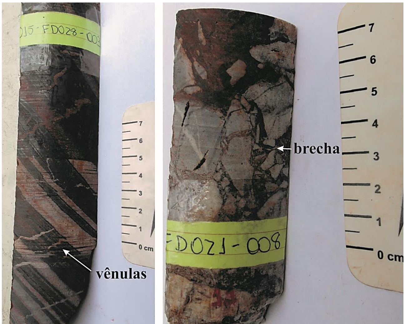
Figura 4.1: Principais feições geológicas encontradas nos itabiritos silicosos e minério de ferro da jazida Minerita.
