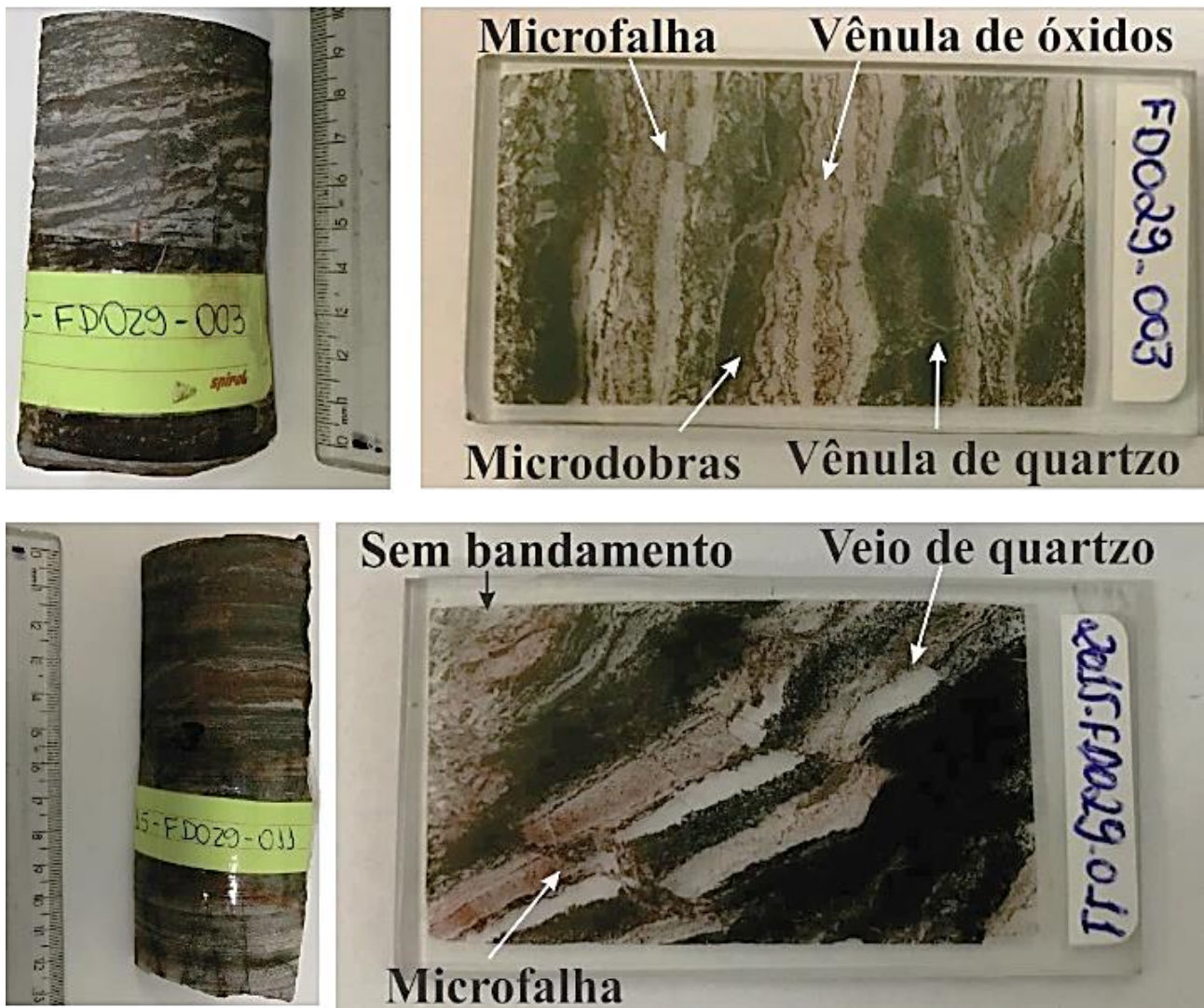
Figura 4.15: Amostras e lâminas de brecha itabirítica (BI) com microdobradas; microfalha; veio e vênulas de quartzo; vênulas de óxidos de ferro; e áreas sem bandamento.
