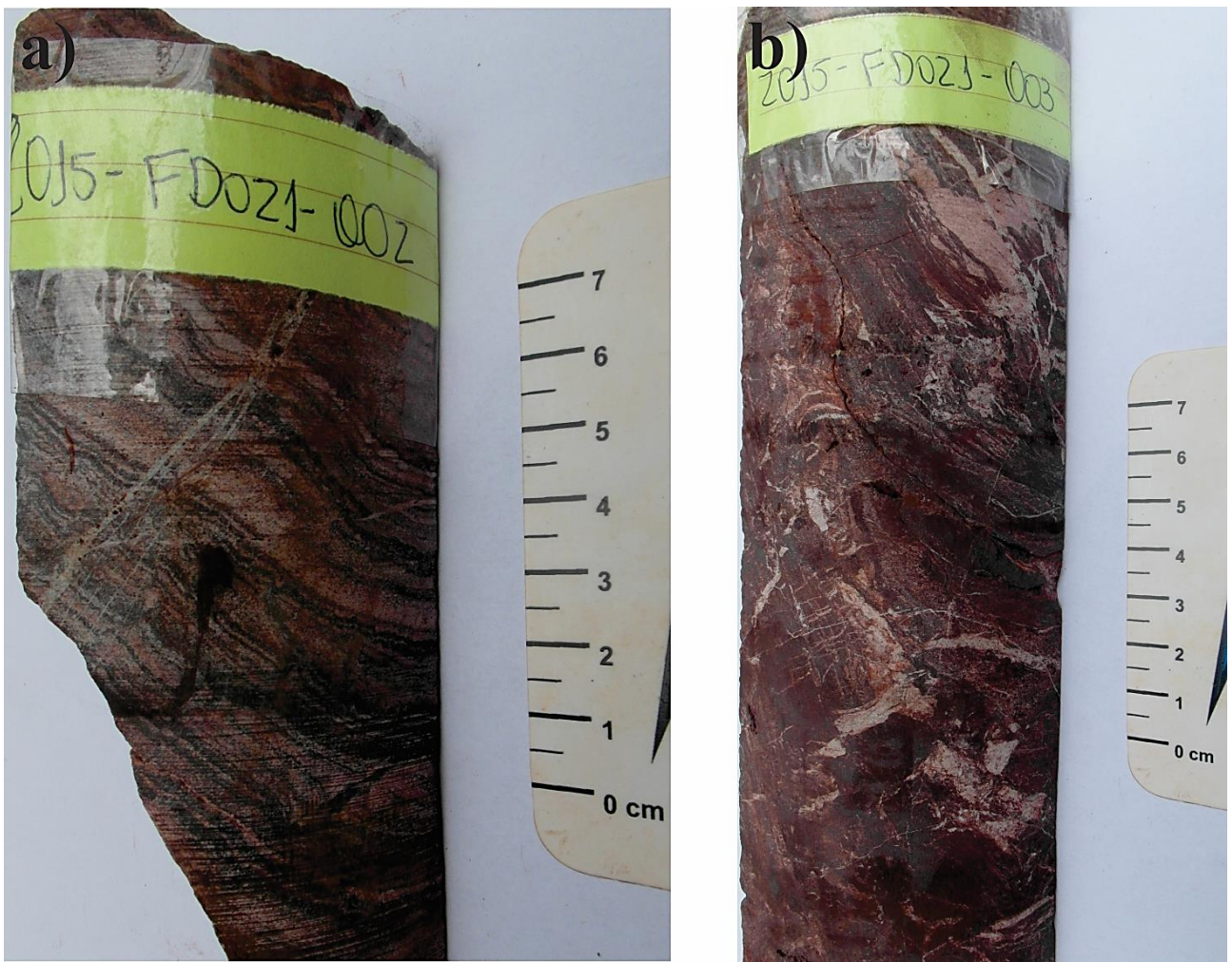
Figura 4.2: Amostras de itabirito e brecha itabirítica da mina Minerita. a) Itabirito silicoso. b) Brecha itabirítica.
