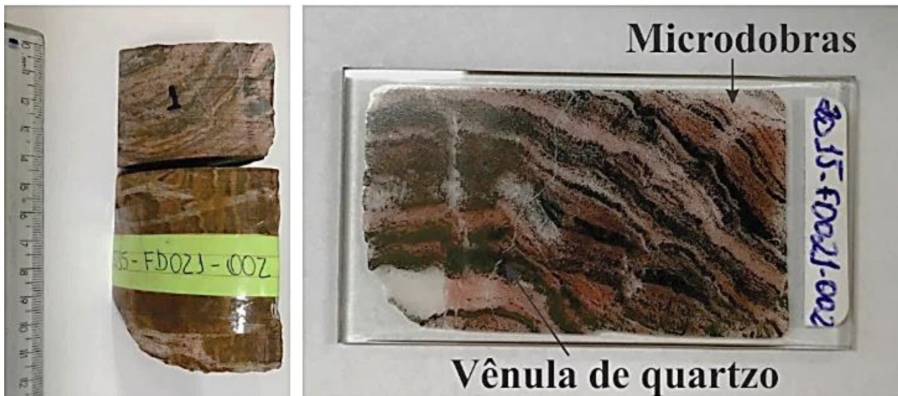
Figura 4.11: Amostras e lâminas de itabirito silicoso (IS) com microdobras; veio e vênulas de quartzo; e vênula de óxidos de ferro.
