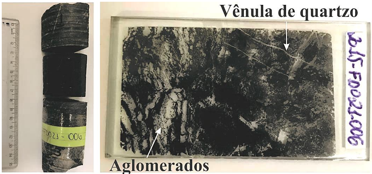
Figura 4.19: Amostra e lâmina de minério de ferro maciço (MM) com textura homogênea; vênula e aglomerados de quartzo.
