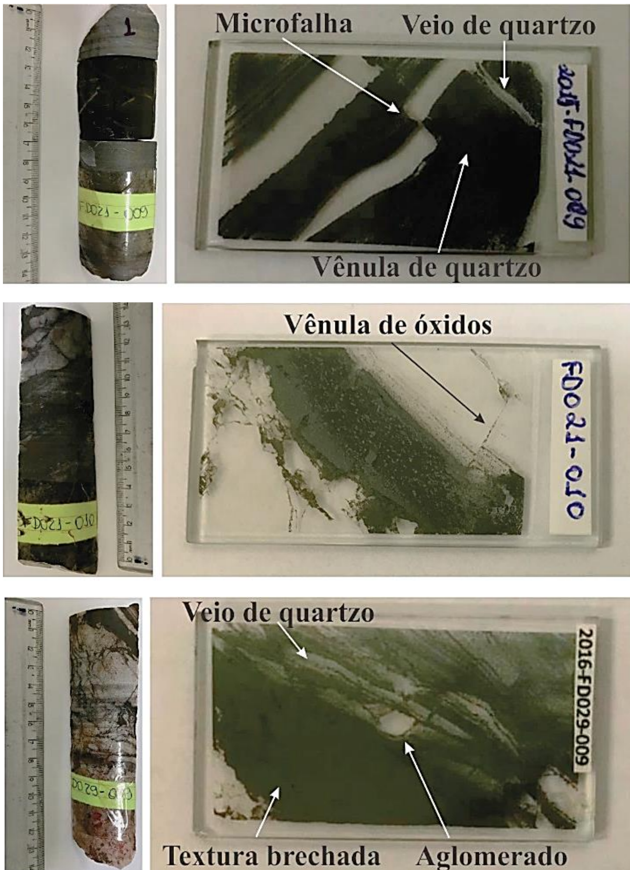
Figura 4.17: Amostras e lâminas de minério de ferro quartzo venulado (MQV) com textura brechada; microfalha; veio, vênula e aglomerado de quartzo; e vênula de óxidos de ferro.
