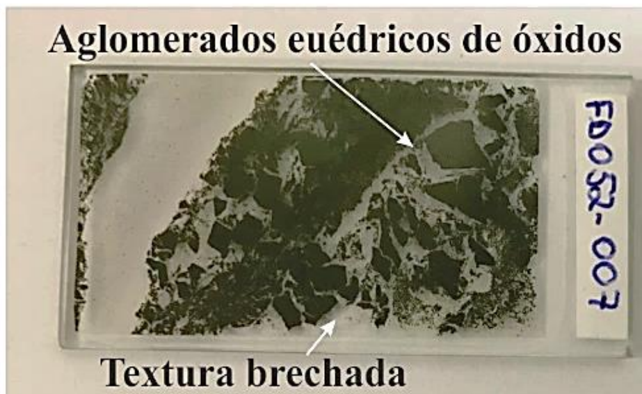
Figura 4.21: Amostras e lâminas de brecha com sulfetos (BS) com textura brechada e bandamento, aglomerados euédricos de óxidos de ferro, veio com sulfetos, e áreas desprovidas de bandamento.
