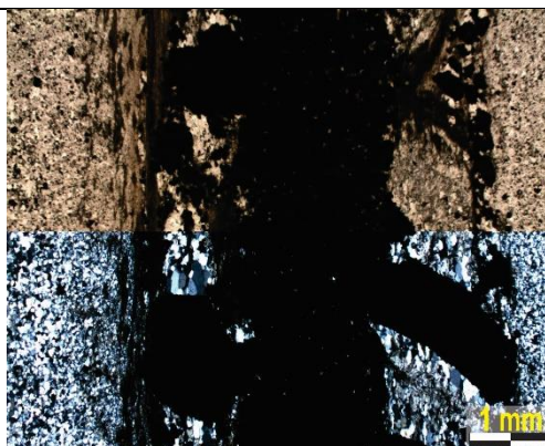
Camada com magnetita hidrotermal (LT/NP/NC)
