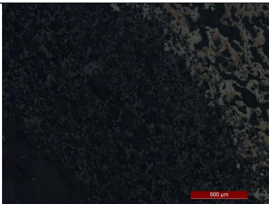
Transição de nível rico em magnetita para nível rico em pirrotita (LR/NP)
