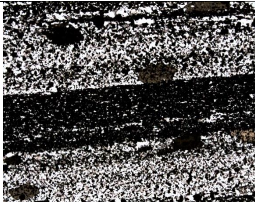
FFB intercalando camadas ricas em magnetita e quartzo e presença de porfiroblastos de biotita (LT/NP)
