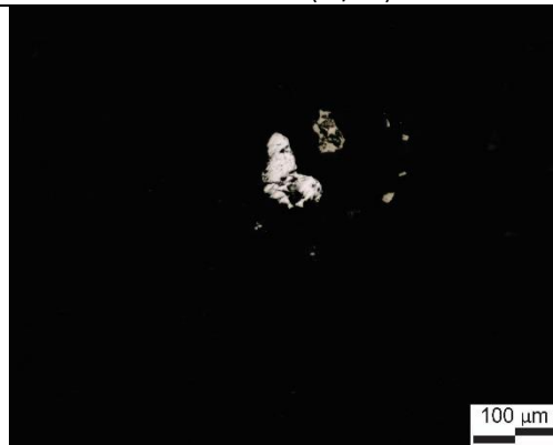
Sulfetos (arsenopirita e pirita) associados a carbonatos secundários (LR/NP)
