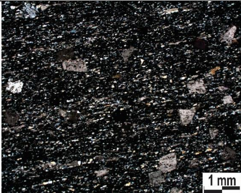
Cristais de carbonato e plagioclásio em matriz quartzo-carbonática (LT/NC)
