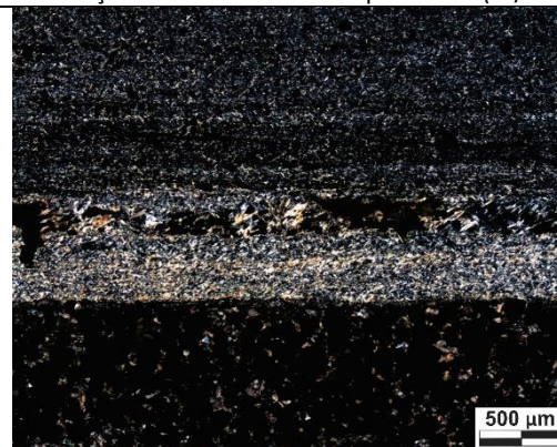
Intercalação entre níveis ricos em magnetita e sericita (LT/NC)
