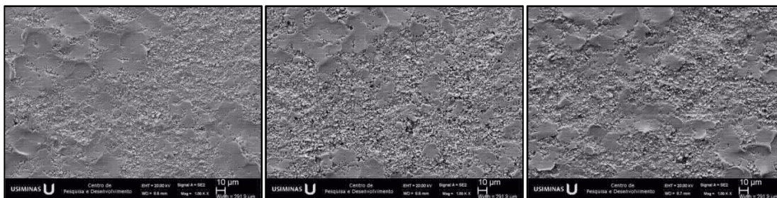
Figura 3.1: Aspecto representativo da superfície das amostras antes da EQ. Aumento original 1000X: (a) GA6 \mu\text{m} ; (b) GA8 \mu\text{m} ; (c) GA11 \mu\text{m} .
