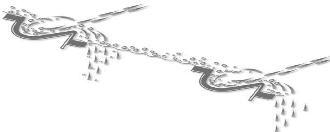
Figura 3.4 - Sistema de spray para peneira Repulp (Clark, 2007)
