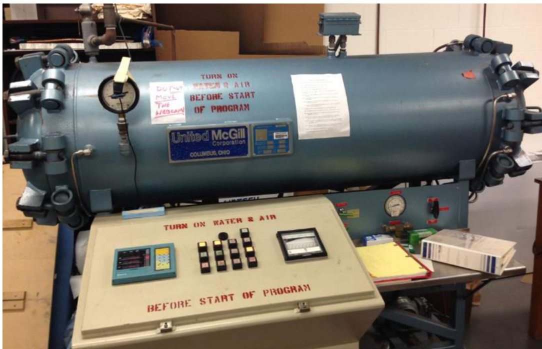
Figura 36: Autoclave onde as amostras foram curadas.
