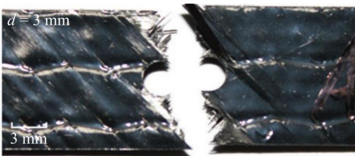
**Figura 46** - Corpo de prova fraturado em tração unidirecional (Arteiro, et al., 2013)
