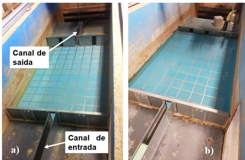
Legenda: (a) identificação dos canais de entrada e de saída, (b) ensaio com água limpa em curso, com vazão de 1,00 L/s.
