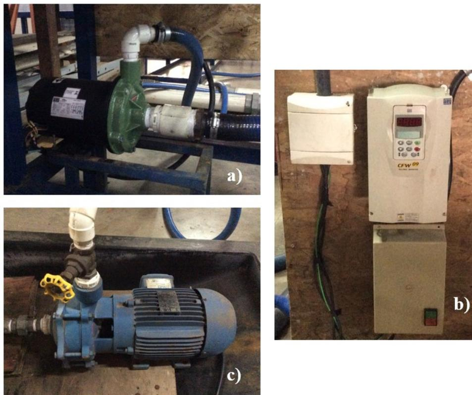
Legenda: (a) bomba para fornecimento de água ao reservatório, (b) inversor de frequência para controle da velocidade de rotação da bomba, (c) bomba para restituição da vazão defluente ao reservatório auxiliar
