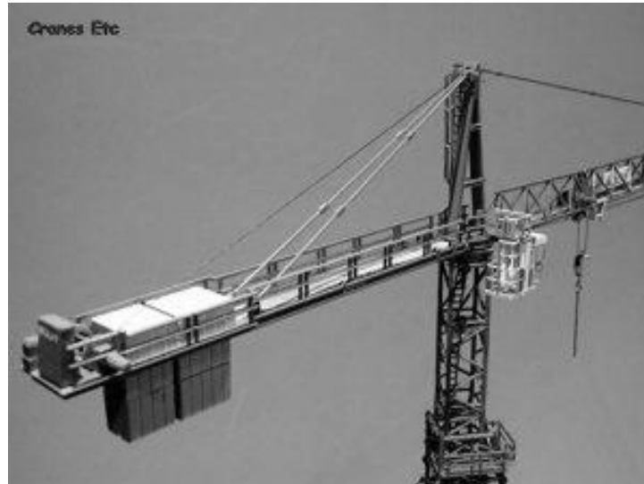
Figura 4: Braço menor horizontal com contrapesos de concreto. Fonte: Blog Engenharia Estrutural e Construção Civil, 2012.
