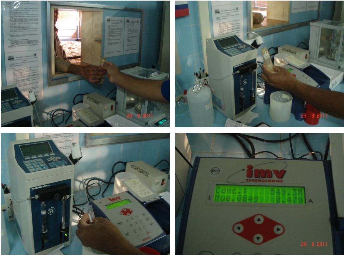
Figura 26 – Após o recebimento da amostra procedeu-se a análise da concentração espermática das amostras utilizando um espectrofotômetro com diluidor automático de sêmen (Accucell® bovine photometer, Modelo n° 704, IMV Technologies). Laboratório da ABS Pecplan, Uberaba, MG – 2011
