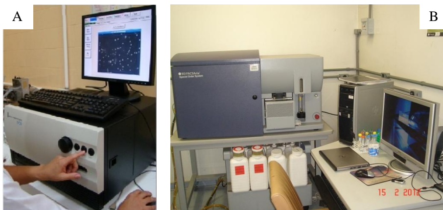
Figura 32 – Fotos dos equipamentos utilizados nas análises pós-descongelamento. (A) Aparelho de análise computadorizada de sêmen IVOS (Versão 12.3, Hamilton-Thorne Research). (B) Citômetro de fluxo FACSAria (Beckton-Dickeson®, Sunnyvale, CA, USA)
