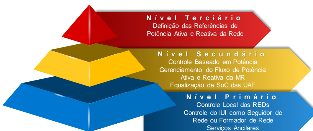
Figura 2.3: Estrutura de Controle Hierárquico da MR Híbrida.
