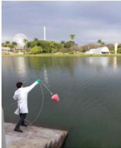
Figura 1: Amostragem, utilizando um balde e corda.
