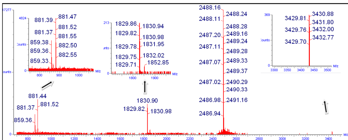
Figura 19- Espectro full scan da amostra de cadeia B de Insulina Humana Recombinante ,obtido por Maldi TOF MS, onde são respectivamente encontrados os íons de m/z 3429.70[M+H] + , 2487.11[M+H] + , 1852.85[M+Na] + , 1829.86[M+H] + , 881.44[M+Na] + e 859.36[M+H] + .
