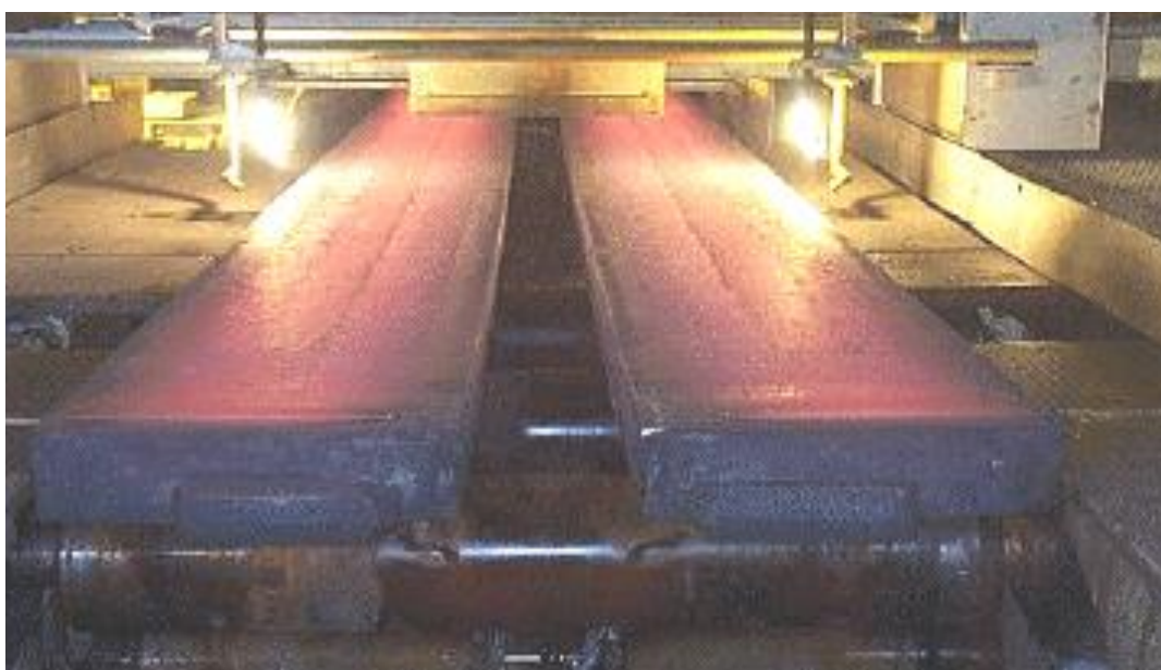
Figura 4.1 - Placas geradas por processo de lingotamento contínuo (Usiminas, 2007).
