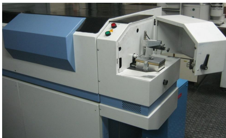
Figura 13 - Espectrômetro de Emissão Ótica – SPARK – Modelo ARL 4460 (Usiminas; 2018).
