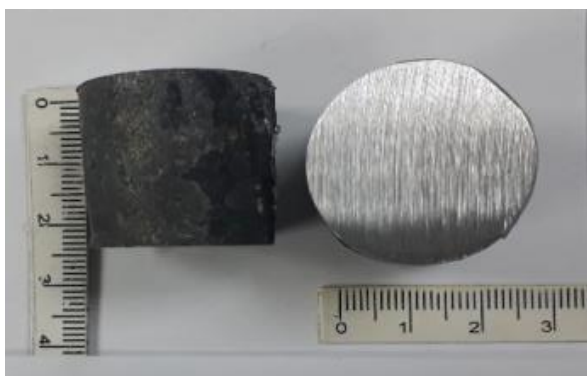
Figura 3.6 - Amostra retirada no lingotamento (Usiminas; 2018).
