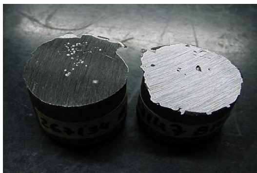
Figura 3.7- Amostra com defeito retirada durante lingotamento contínuo (Usiminas; 2018).
