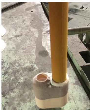
Figura 3.4 - Amostrador do tipo coquilha usada no lingotamento ( Usiminas; 2018).
