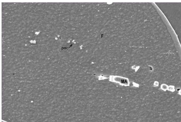
Figura 3.13 - Estrutura de solidificação da amostra laminada (PIMENTA E.P.S, 2008).
