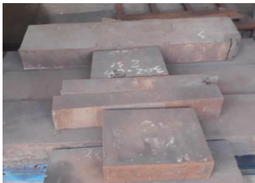
Figura 4.3 - Exemplo de amostras de placa de aço utilizadas para análise de Baumann (Usiminas; 2018).
