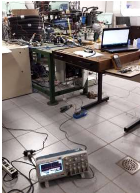
Figura A.8: Procedimento de aferição da potência elétrica (Humia, 2017).
