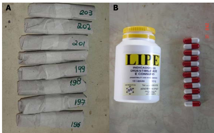
Figura 6 - Indicadores usados na estimativa da produção fecal e consumo. A: Óxido crômico, enrolado em papel de celulose. B: Cápsulas de LIPE®.
