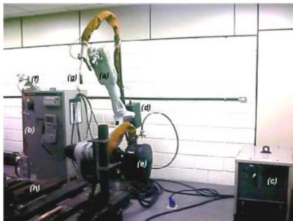
**Figura 16** – Célula robótica para soldagem. a) robô; b) controle do robô; c) fonte de soldagem; d) alimentador de arame; e) rolo de arame; f) cilindro de gás; g) tocha e h) mesa de soldagem.
