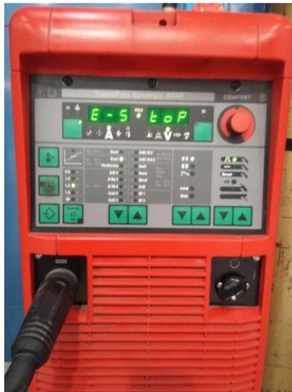
**Figura 20** – Fonte de soldagem TPS 4000
