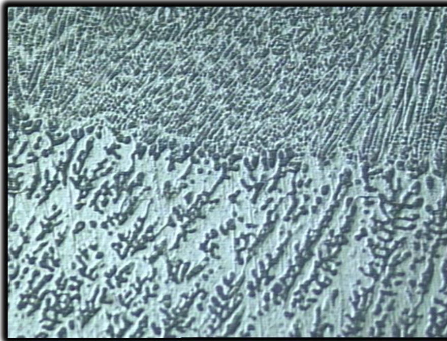
Figura (60) – Zona de ligação da 1ª camada E309 com a 2ª camada E 308 200x – reagente Marble
