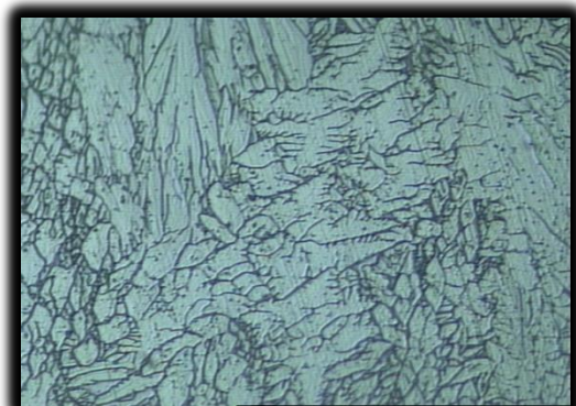
Fig. (51) – 2ª camada: Austenita+Ferrita \delta
