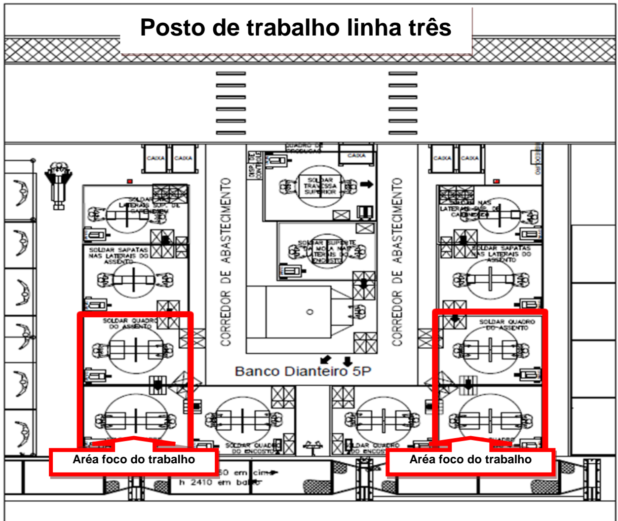
Figura 10: Layout Linha 3- Soldagem manual
