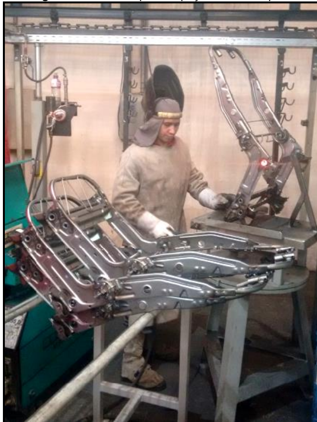
Figura 32: Bancada para inspeção visual e reparo
