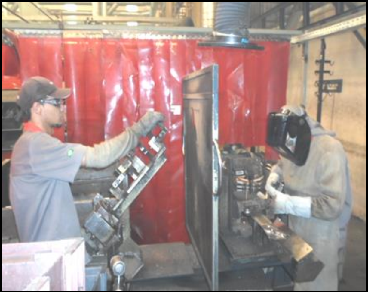
Figura 19: Dispositivo subconjunto lateral ext. e interna do banco dianteiro
