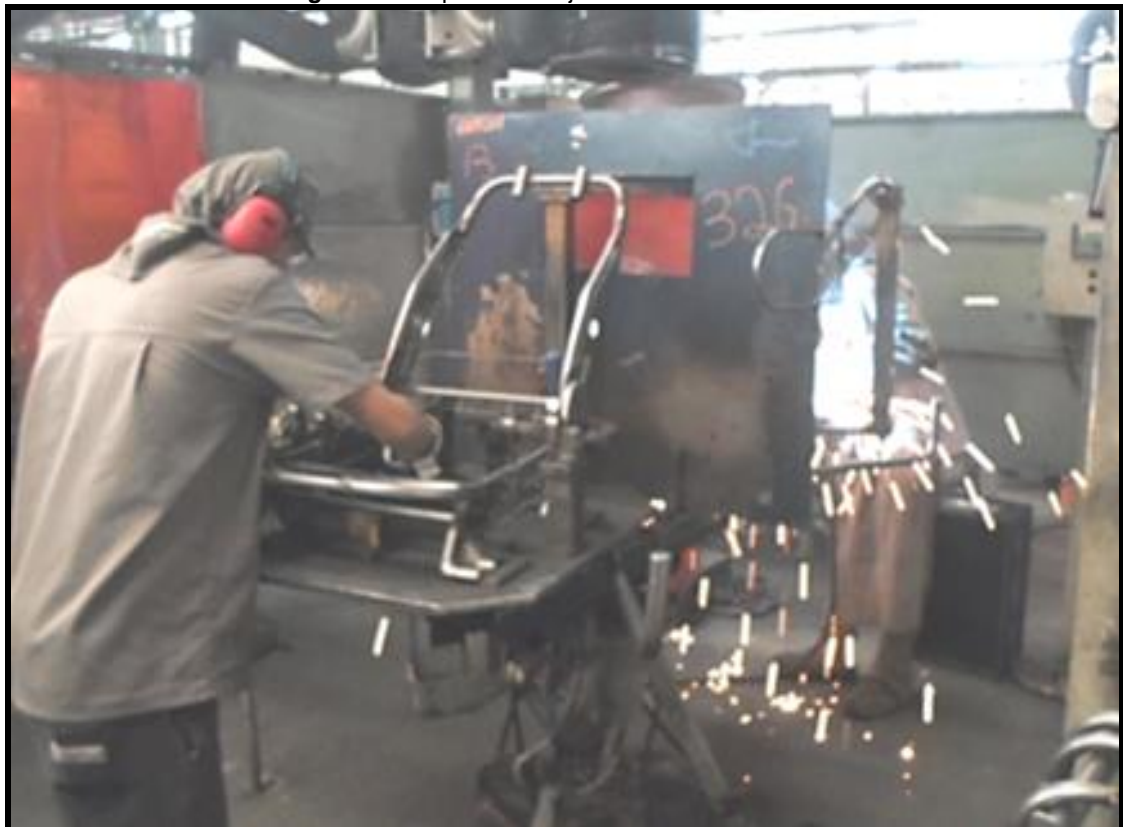
Figura 25: Dispositivo conjunto do assento dianteiro
