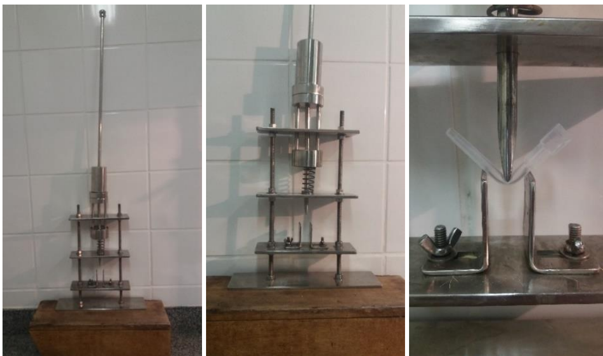
Figura 8: Guilhotina desenvolvida para fraturas diafisárias de fêmur. À esquerda observa-se toda a estrutura. Ao centro um detalhe do peso no fim do trilho. À direita, a ponta da guilhotina com simulação da produção da fratura.
