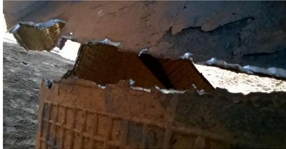
FIGURA 2.21 – Fratura na caçamba provocada por propagação de trincas de fadiga.
