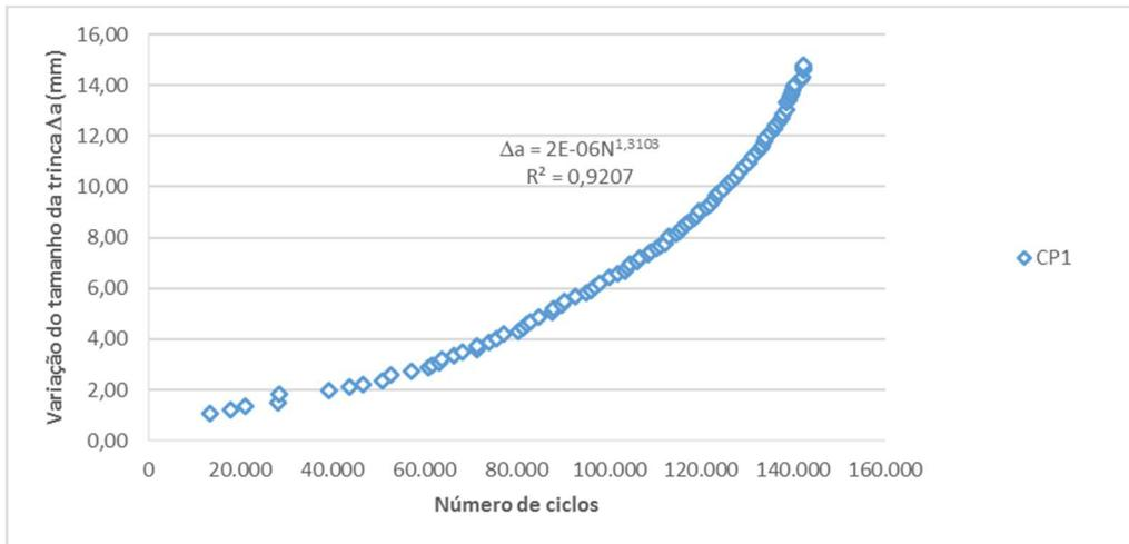
FIGURA 4.7 – Equação do comprimento da trinca vs. Número de ciclos para o CP1, para R=0,1 e Frequência de 30Hz.
