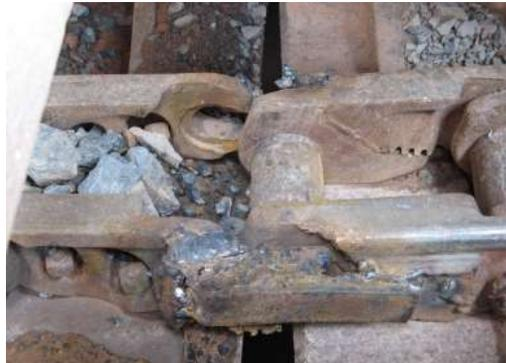
FIGURA 2.17 – Quebra do elo da corrente de um alimentador de sapatas.
