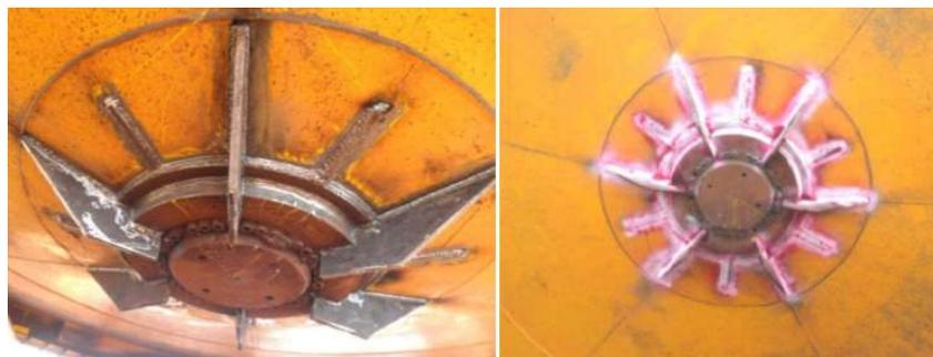
FIGURA 2.20 – Reforço estrutural para a roda que falhou em serviço.
