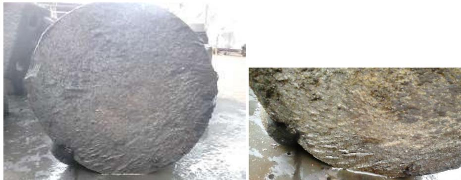
FIGURA 2.18 – Quebra do eixo motriz de um alimentador.
