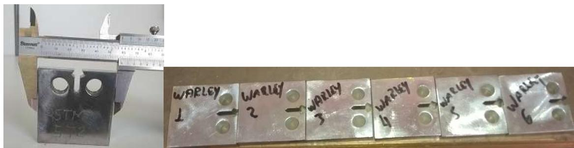
FIGURA 3.8 – Corpo de prova do tipo tração.
