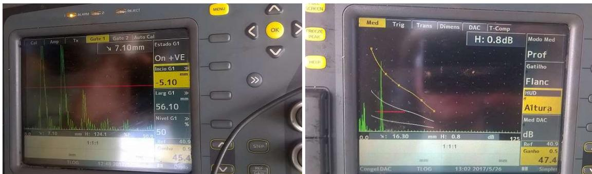
FIGURA 4.4 – Resultado da localização da trinca no eixo Z.
