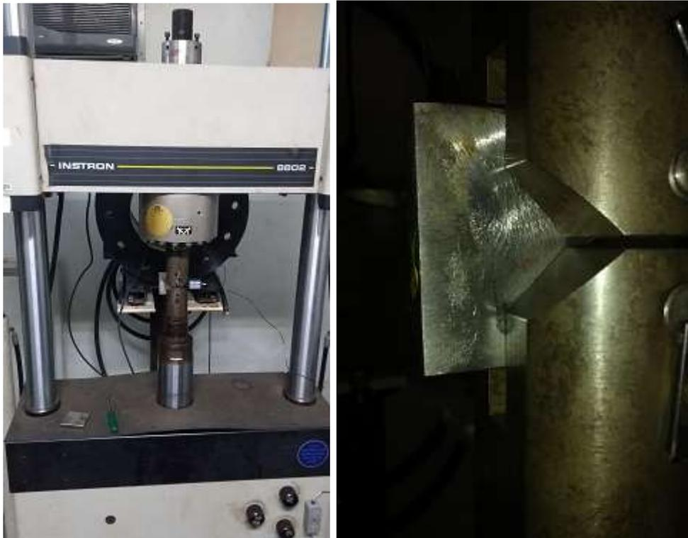
FIGURA 3.9 – Corpo de prova montado na máquina de ensaio de fadiga.
