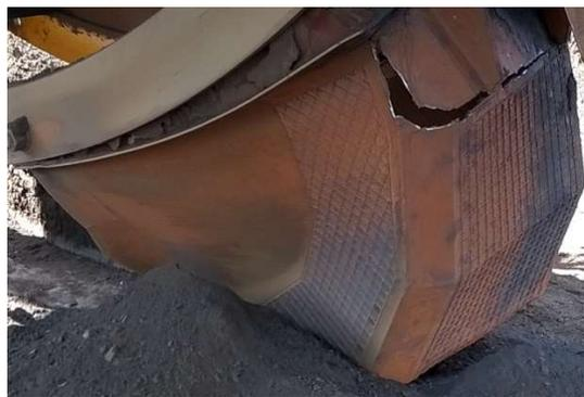
FIGURA 3.6 – Caçamba utilizada para obtenção de amostras do material para ensaio de fadiga.
