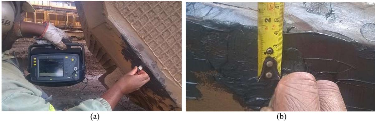
FIGURA 3.5 – a) Execução do ensaio de ultrassom; b) Ponto da trinca identificada.
