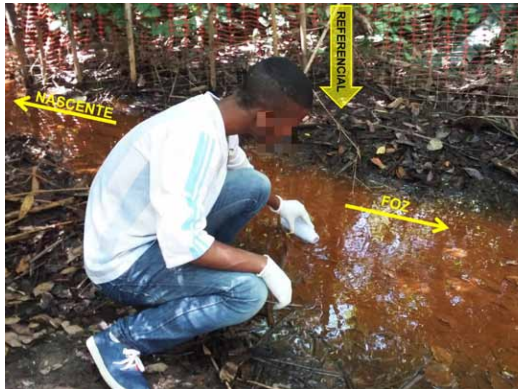
Figura 5.6 – Coleta de água para análises de parâmetros físicos e químicos, onde o referencial é definido contra a correnteza (de montante – nascente para jusante – foz).
