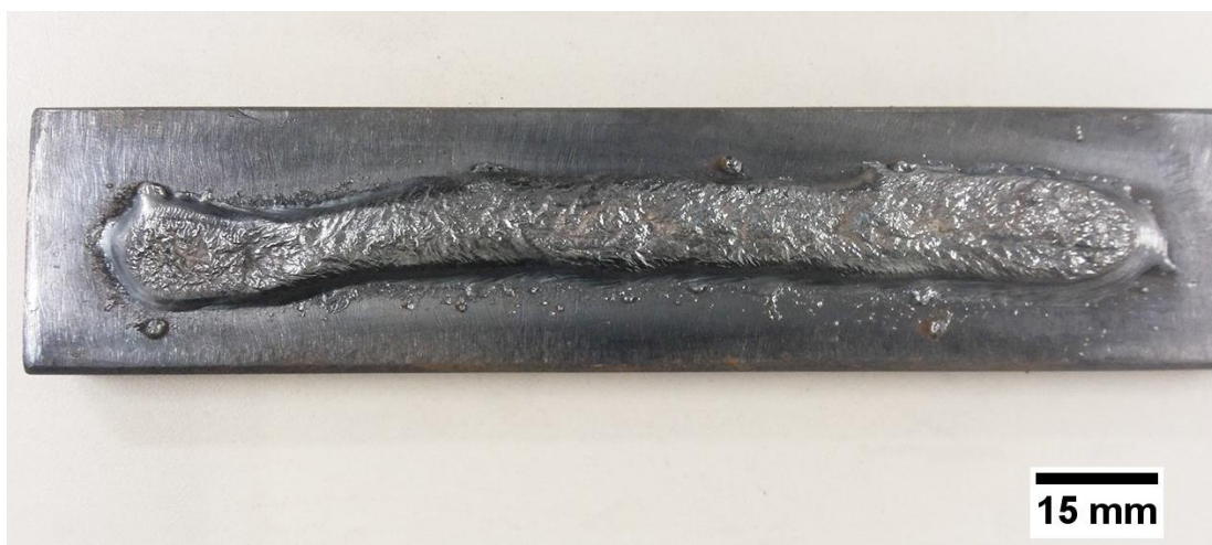
Figura 4.12 – Cordão de solda formado com o arame GAT-TiCe (CP7).
