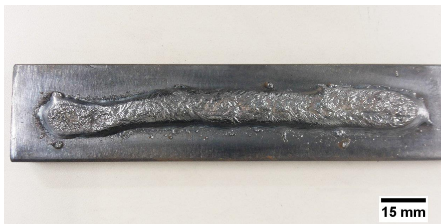
Figura 4.3 – Cordão de solda formado com o arame GAT-TiCe (CP2).
