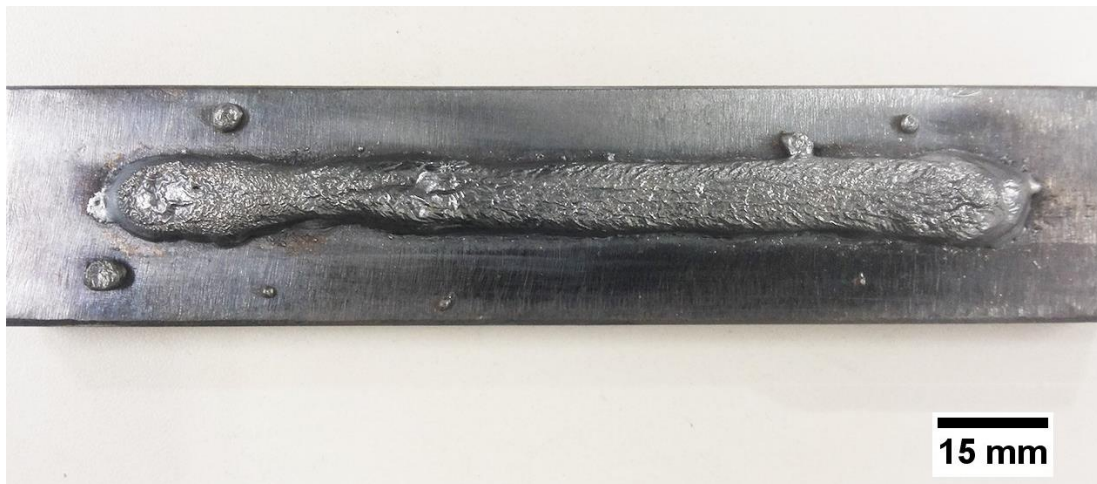
Figura 4.11 – Cordão de solda formado com o arame GAT-TiC (CP4).
