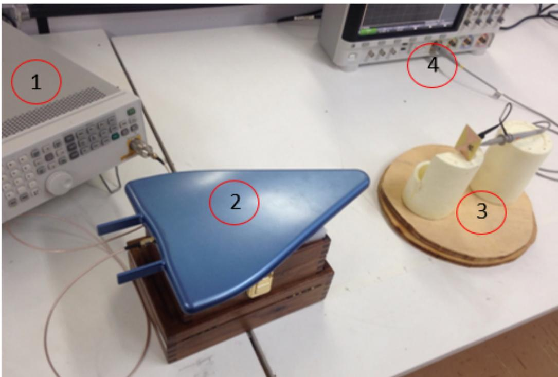
Figura 62 – Setup utilizado para medição de reaproveitamento de energia das rectenas O1 e O3.
