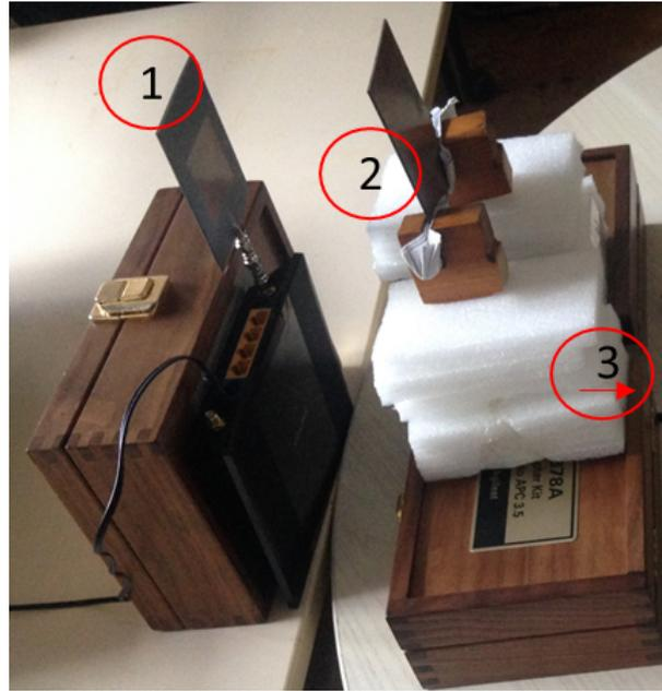
Figura 50 – Setup de medição utilizando como transmissora antena de  $50\Omega$  ligada ao roteador.
