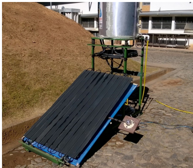
FIGURA 4.5 – Formação de água na superfície do evaporador. FONTE: O autor, 2019
