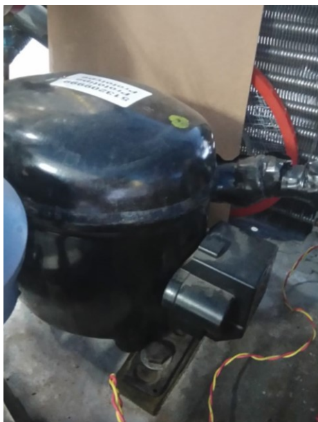
FIGURA 3.10 - Compressor Hermético Embraco. FONTE: o autor, 2019.
