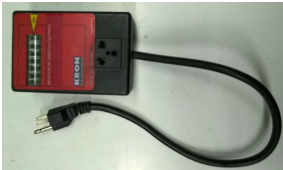
FIGURA 3.18 - Instrumento utilizado para medição da energia elétrica consumida no compressor. FONTE: DINIZ, 2017.
