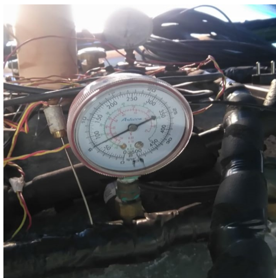
FIGURA 3.3 - Representação dos manômetros instalados na máquina. FONTE: o autor, 2019.
