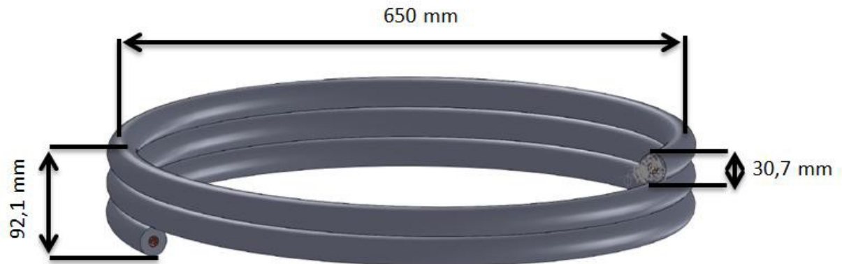
FIGURA 3.14 - Detalhe construtivo do condensador coaxial. FONTE: DINIZ, 2017.
