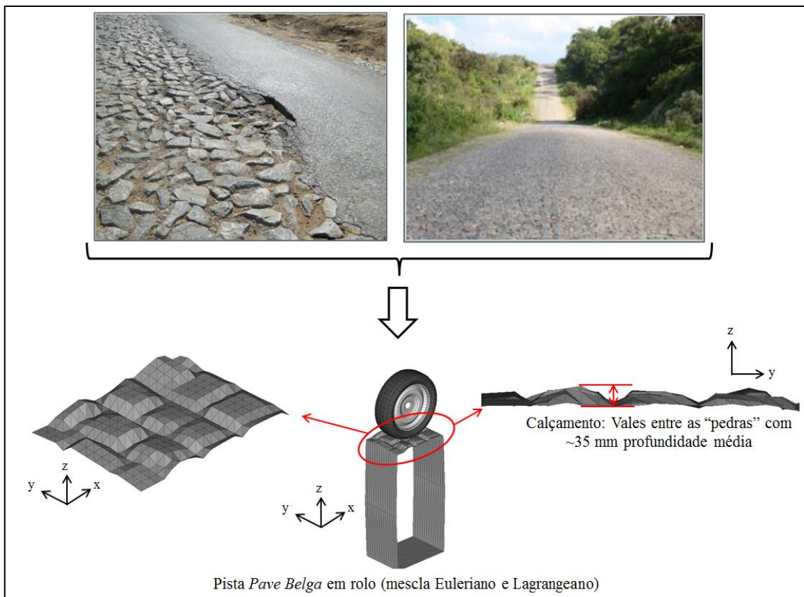
FIGURA 3.5 – Perfil da pista virtual digitalizada Pave Belga (calçamento)
