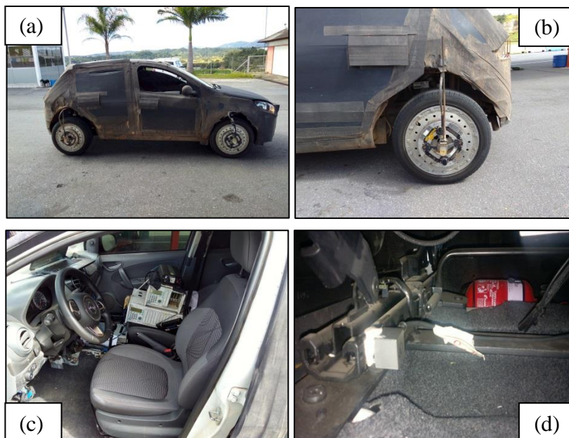
FIGURA 2.23 – Carro protótipo instrumentado para o LDS conforme norma FCA LP.7T0 15. (a) – Veículo pronto para o teste; (b) detalhe da roda dinamométrica para a medição de cargas no centro roda; (c) Instrumentação no interior do veículo; (d) exemplo de um acelerômetro colado no trilho do banco.
